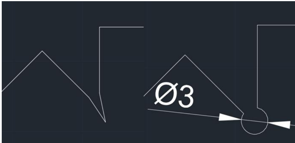
Slika 39. Konstrukcijsko rješenje 1: prije (lijevo), poslije (desno)
