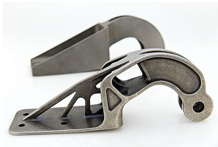
Slika 16. Primjer strukturne toploške optimizacije [7]
