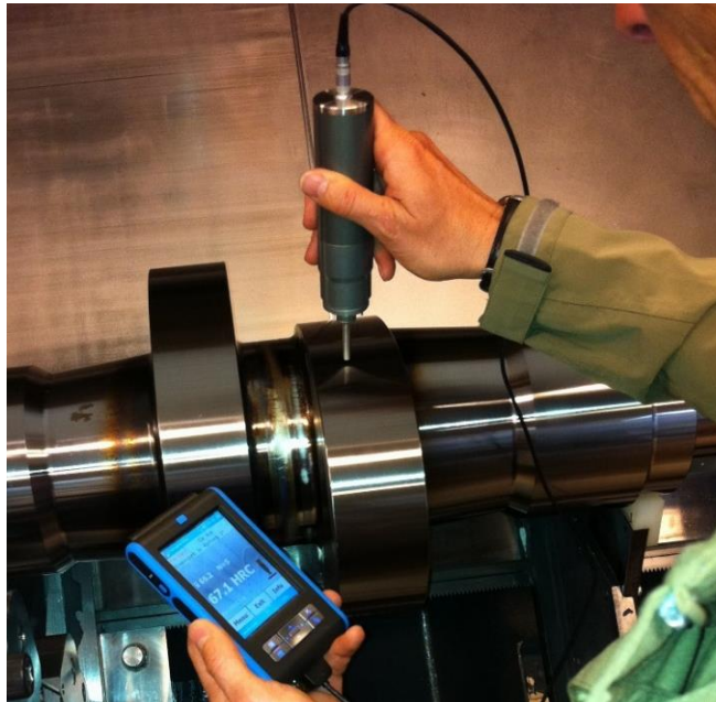
Slika 19. Ispitivanje UCI metodom na poliranim površinama [2]
