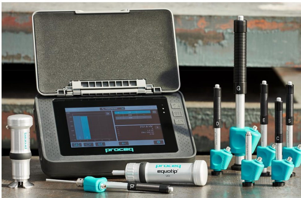
Slika 23. Kombinirani uređaj Proceq Equotip 550 sa različitim sondama [12]
