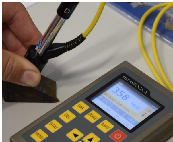
Slika 47. Ispitivanje uzorka kada je sonda nagnuta
