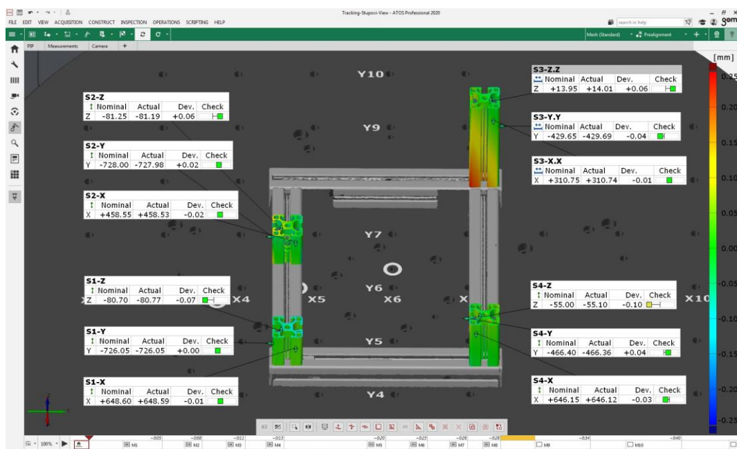
Slika 2-12 Rezultat optičkog pozicioniranja stupova
