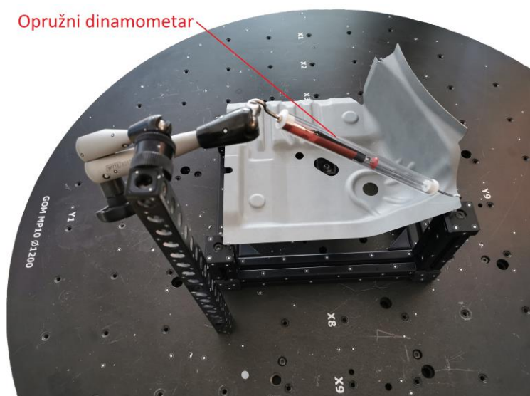
Slika 3-9 Lim opterećen dinamometrom
