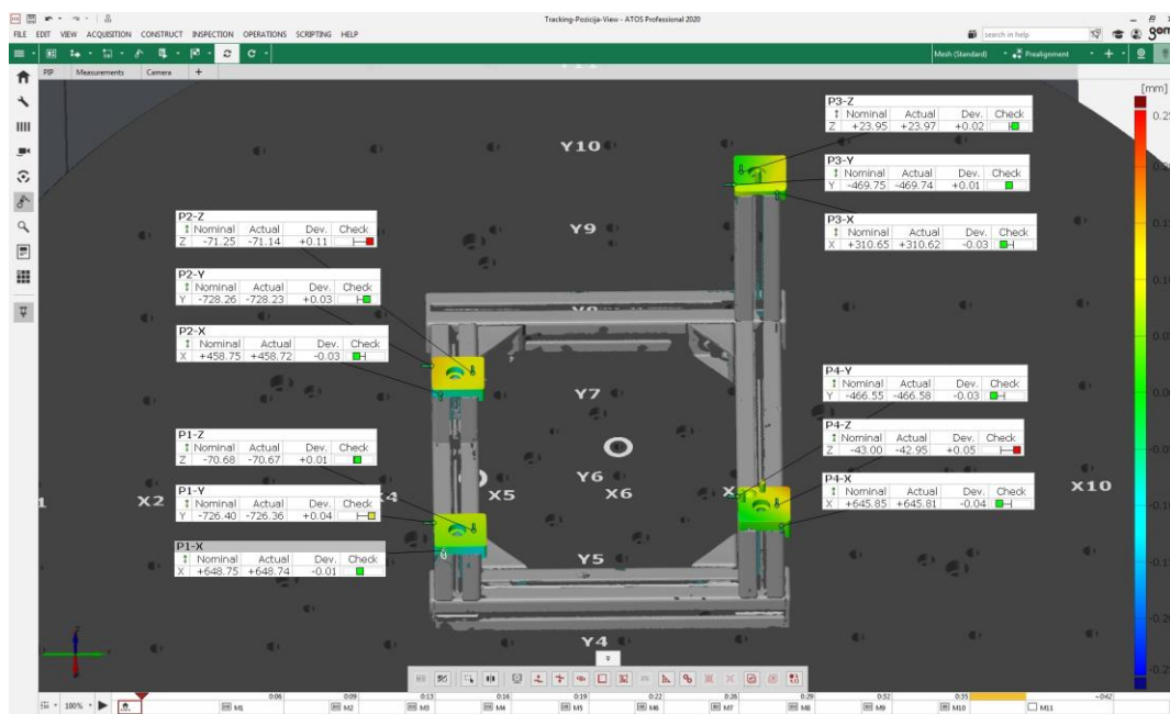
Slika 2-13 Rezultat optičkog pozicioniranja pokrova aluminijskih profila
