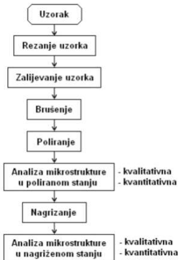
Slika 17. Shematski prikaz pripreme i metalografskog ispitivanja uzorka [22]
