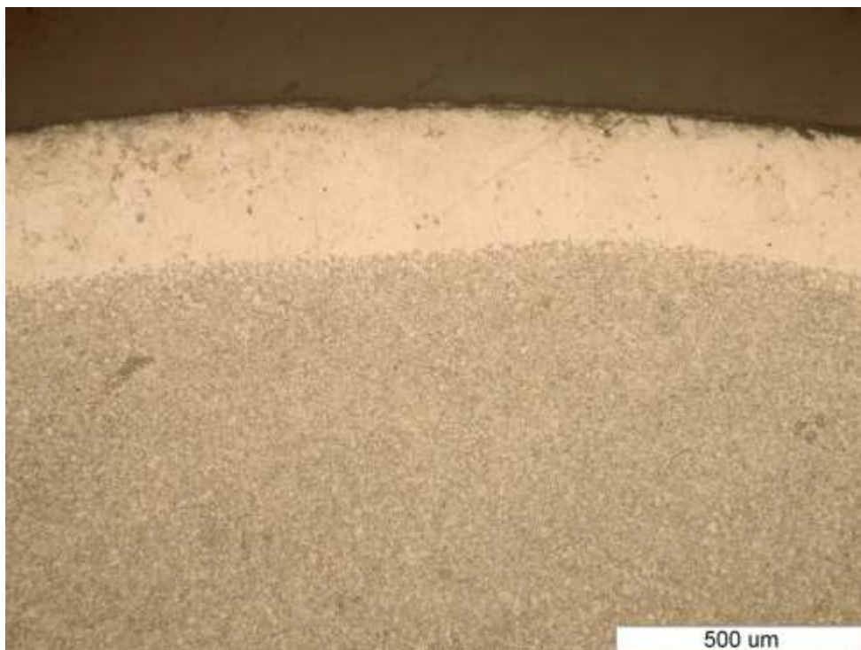
Slika 49. Mikrostruktura uzorka 3 kod ruba pri povećanju od 100x
