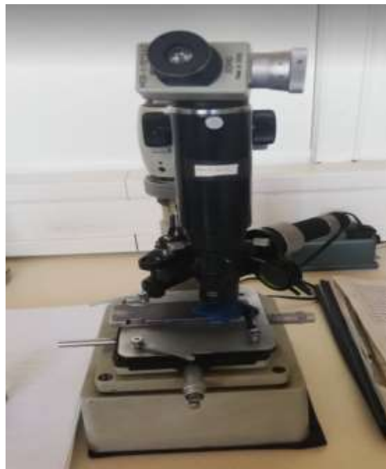
Slika 61. Uređaj za mjerenje mikrotvrdoće uzorka
