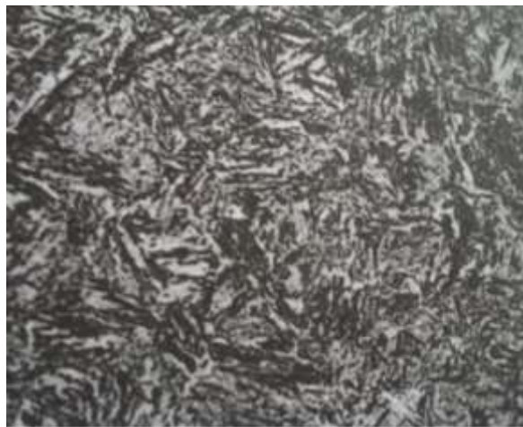
Slika 6. Mikrostruktura poboljšanog čelika- visokopušteni martenzit [11]
