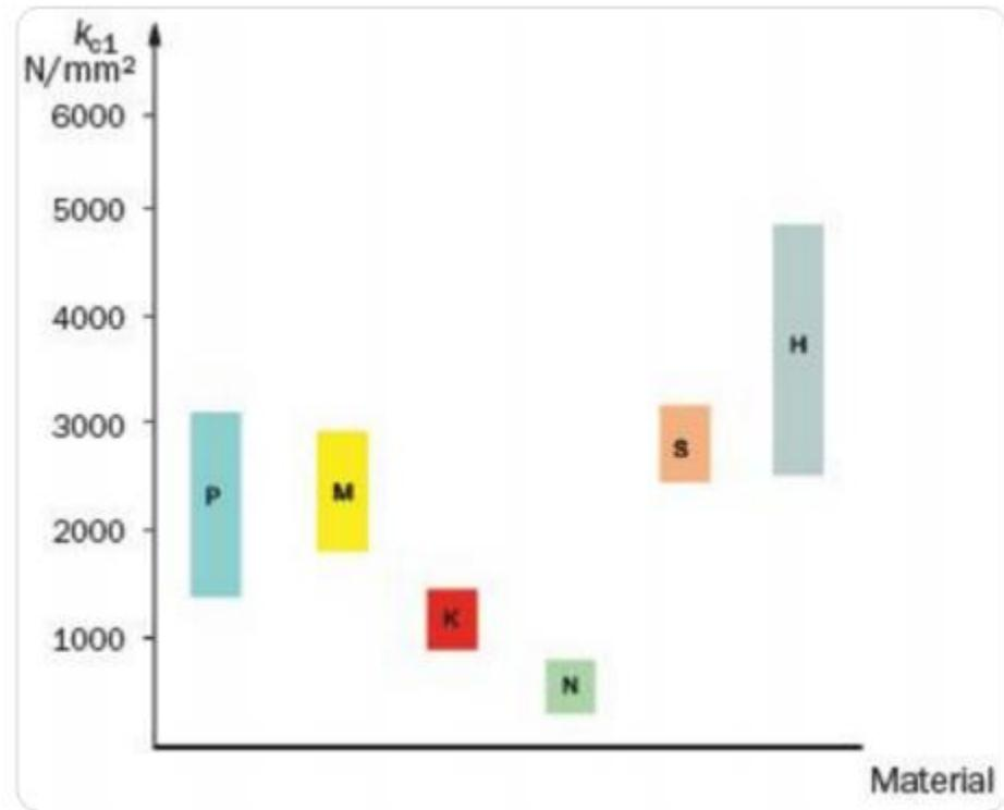
Slika 7.2 Dijagram ovisnosti specifične sile rezanja u materijalu
