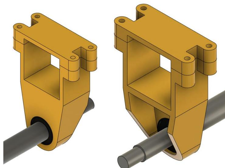
Slika 7.59 Nosač navojnog vretena X osi
