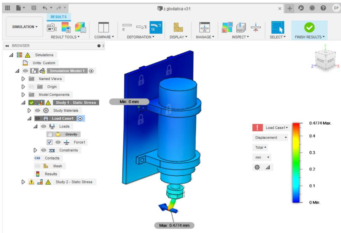
Slika 7.48 Računalno određivanje sila u X smjeru
