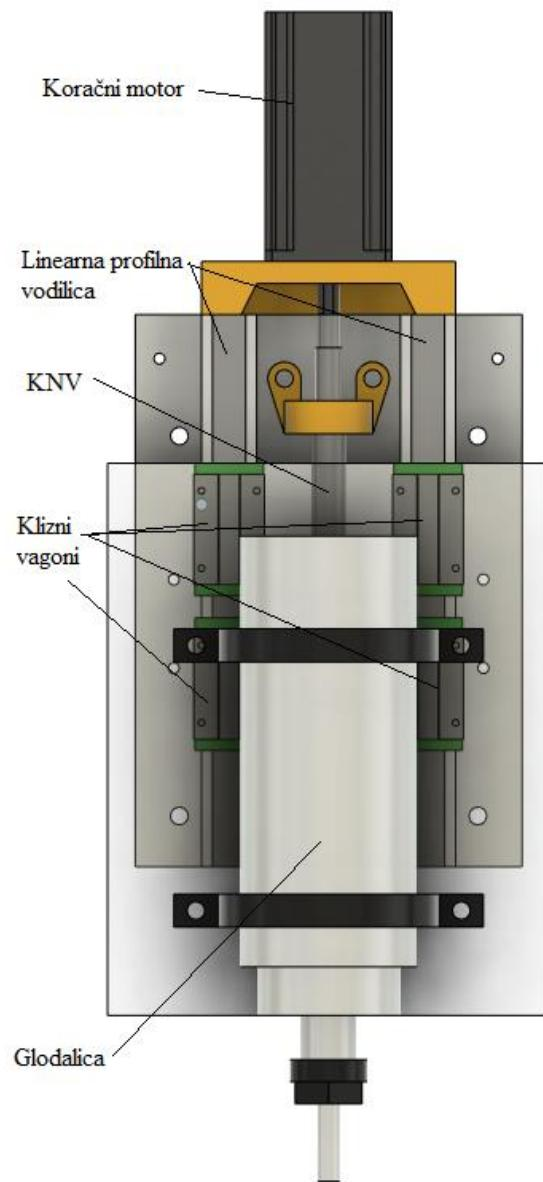
Slika 7.42 Konstrukcija Z osi
