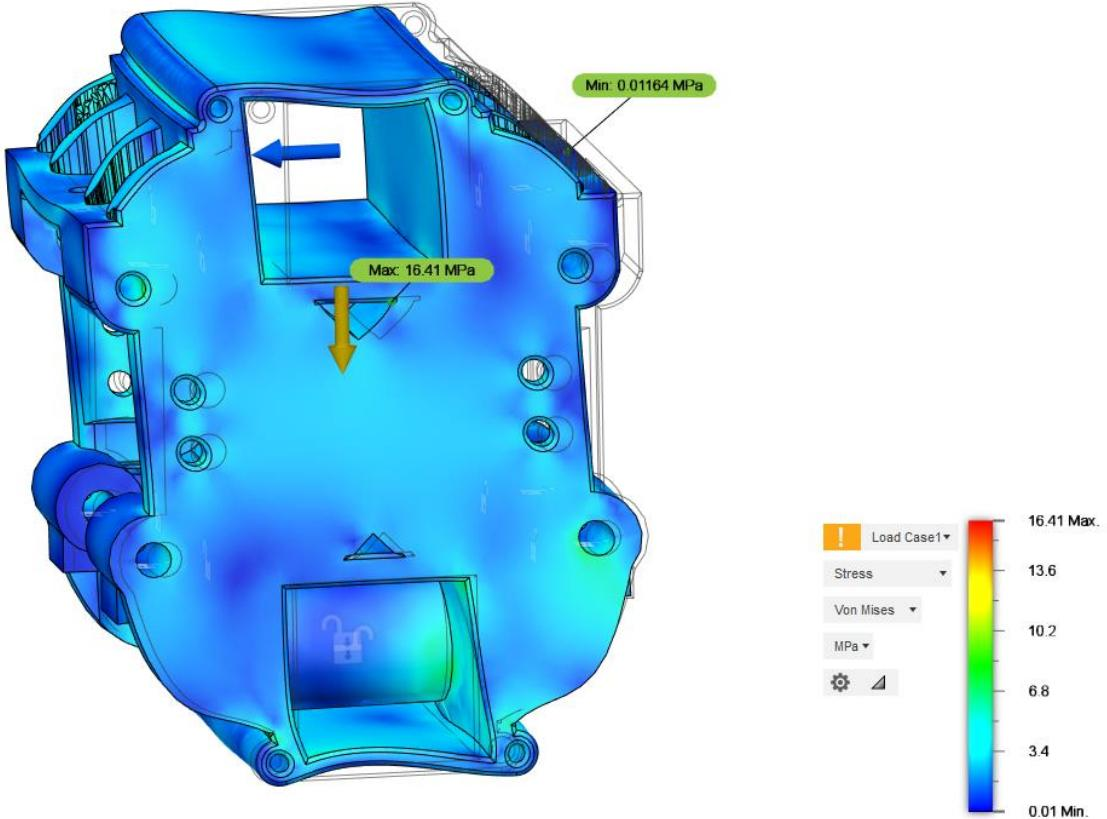
Slika 7.24 Provjera čvrstoće X vodilica
