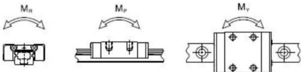
Slika 7.53 Smjerovi opterećenja vodilice
