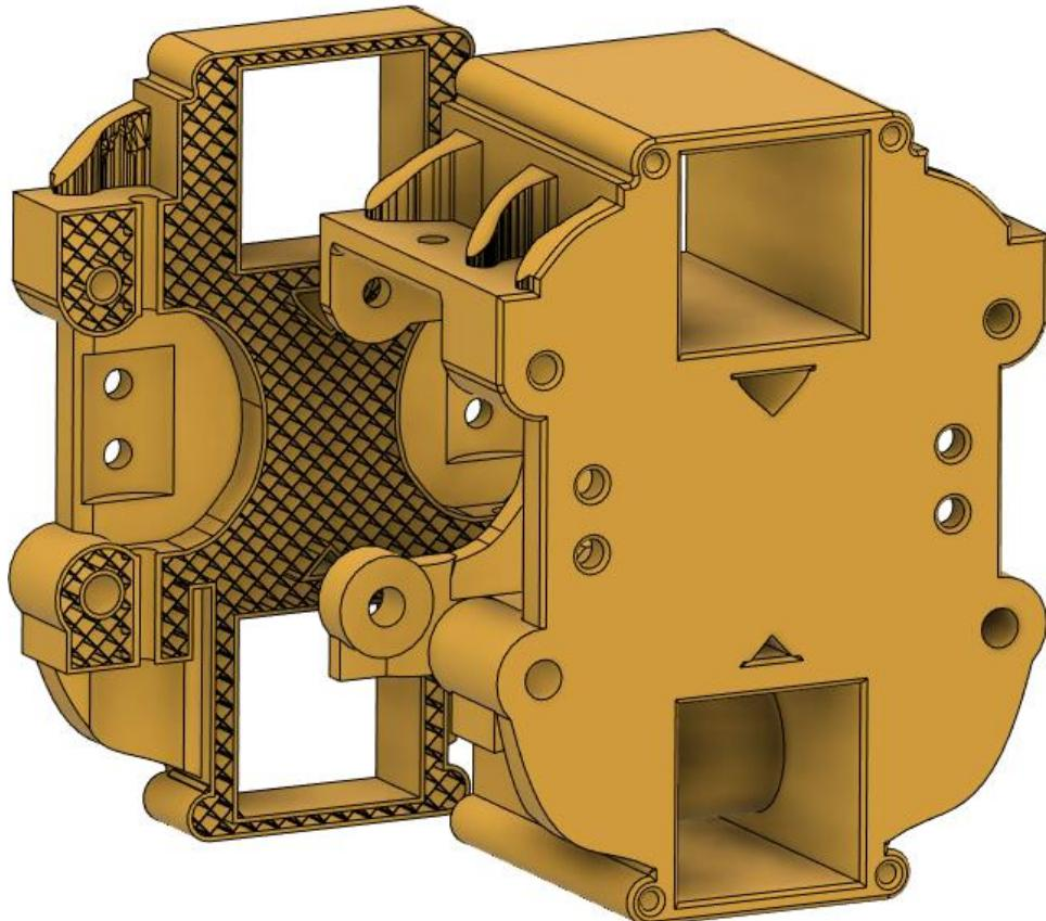
*Slika 7.23 Presjek ispuna X vodilice*
