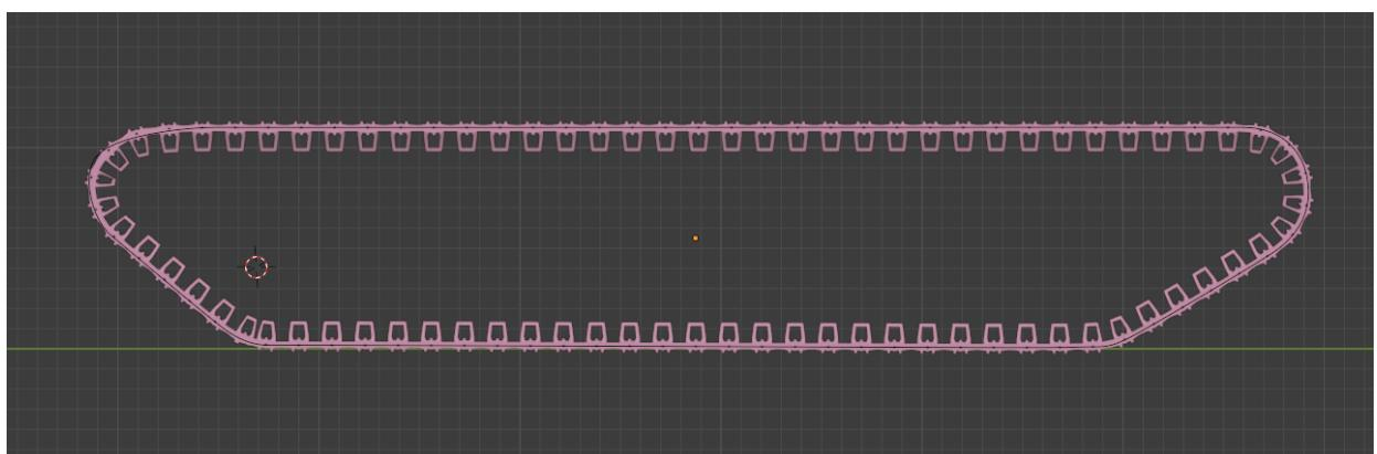
Slika 6.27 Primjenjivanje Array modifikatora na kariku gusjenice
