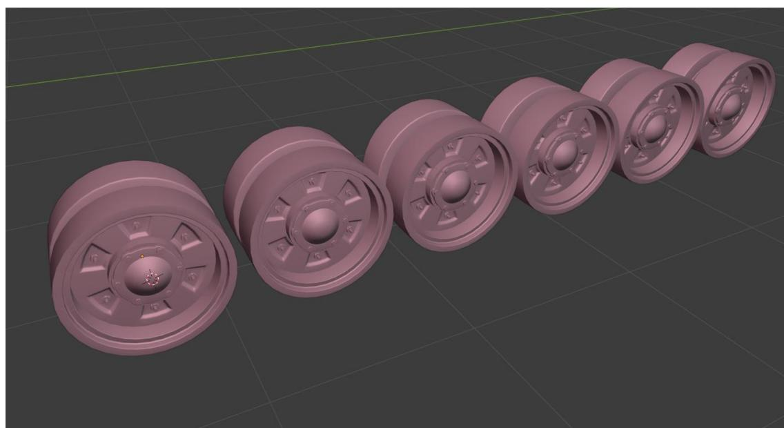
*Slika 6.23 Stvaranje niza kotača pomoću Array modifikatora*
