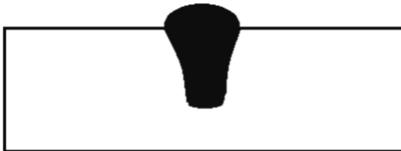
Slika 6.3 Utjecaj ugljikovog dioksida na geometriju zavora
