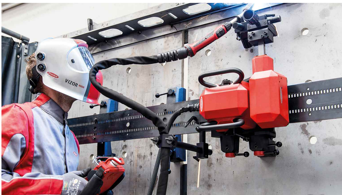
Slika 3.1 Prikaz Fronius automata za MIG/MAG zavarivanje [17]
