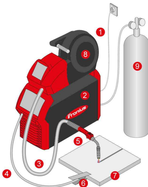
Slika 2.2 Shema Fronius uređaja za MIG/MAG zavarivanje [2]
