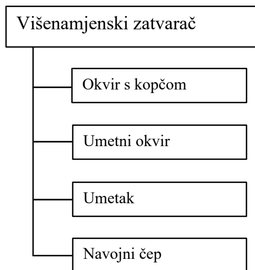
Slika 4.3. Hijerarhijsko stablo višenamjenskog polimernog zatvarača
