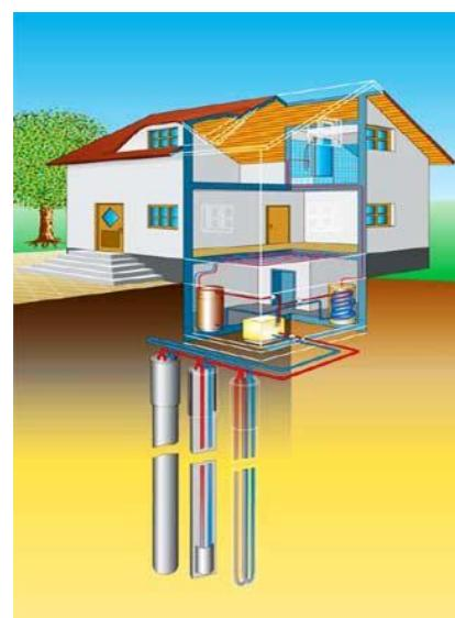
Slika 3. Dubinska sonda (Toplinske pumpe, bez dat.)
