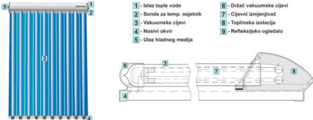
Slika 8. Vakumski cijevni kolektor (Centrometal, bez dat.)
