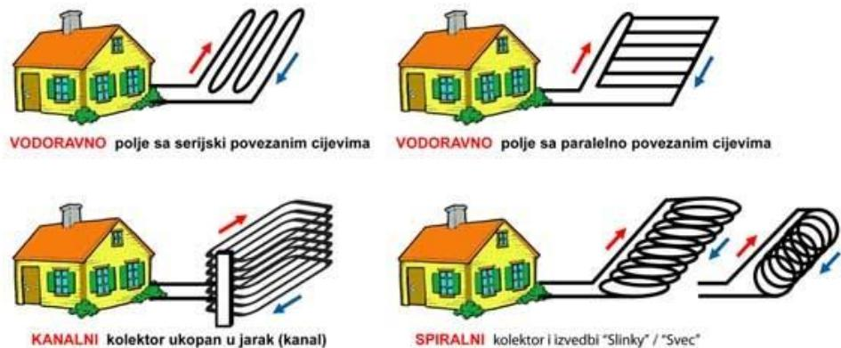
Slika 2. Izvedbe podzemnih kolektora (Toplinske pumpe, bez dat.)
