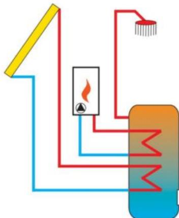
Slika 9. Shema bivalentnog spremnika topline (Žepoh, bez dat.)
