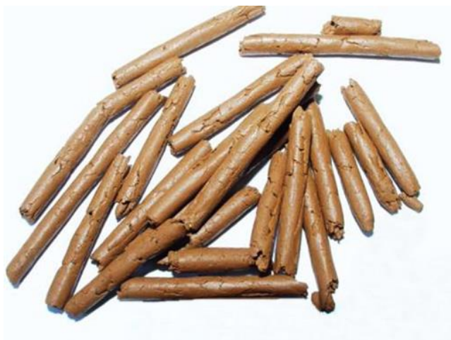
Slika 4.2. Valjčići na granici plastičnosti tijekom ispitivanja
