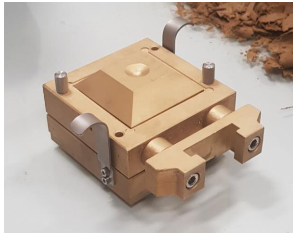
Slika 4.23. Potpuno sastavljena ćelija s ugrađenim ispitnim tijelom
