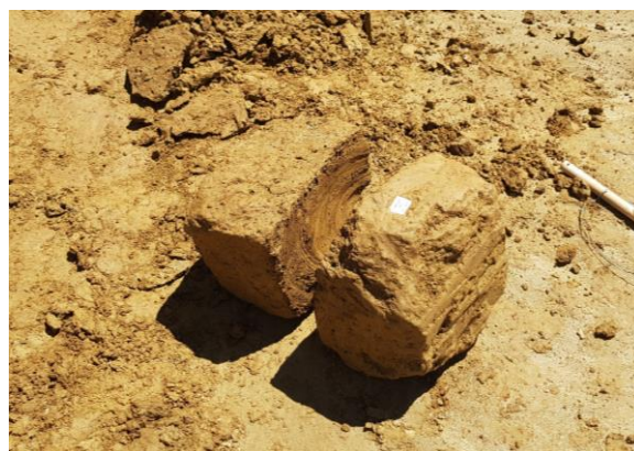
Slika 3.6. Izvađeni uzorak prepolovljen na dva ispitna uzorka
