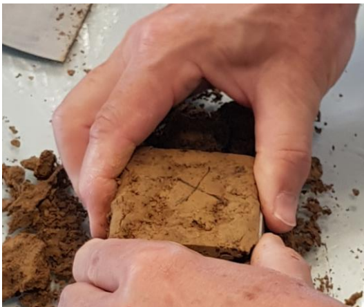
Slika 4.15. Proces oblikovanja ispitnog tijela za smjer smicanja 0^\circ
