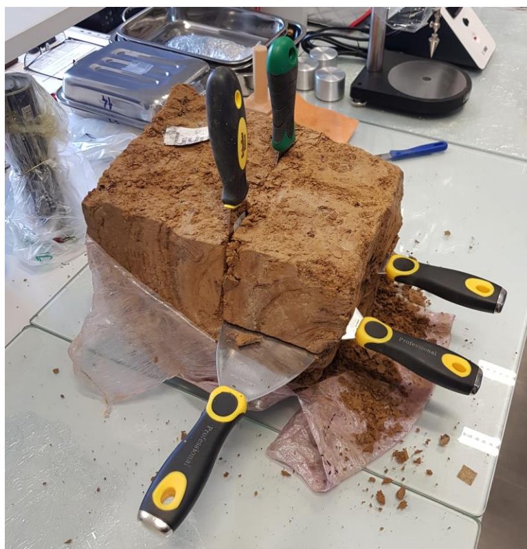
Slika 4.14. Proces izdvajanja dijela ispitnog uzorka za pripremu ispitnih tijela
