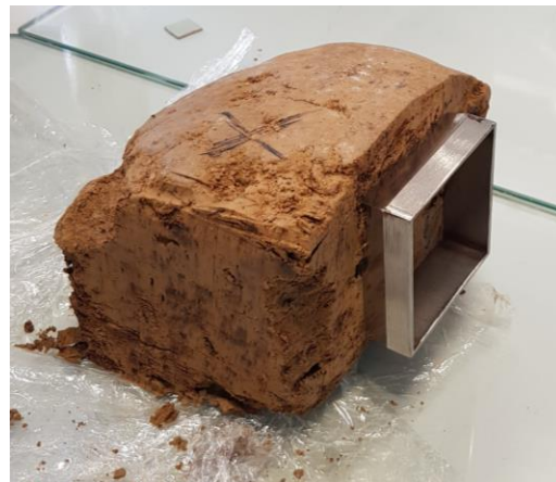
Slika 4.16. Proces oblikovanja ispitnog tijela za smjer smicanja 90^\circ
