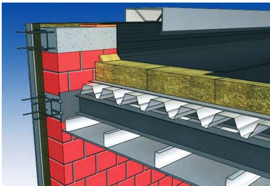
Slika 13. Slojevi neprohodnog ravnog krova
