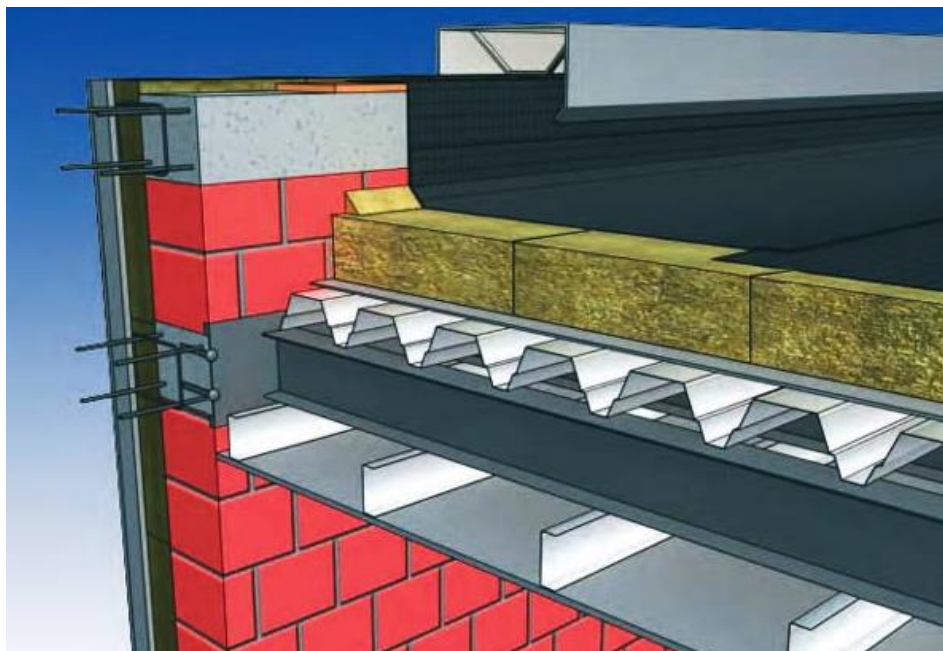
Slika 13. Slojevi neprohodnog ravnog krova
