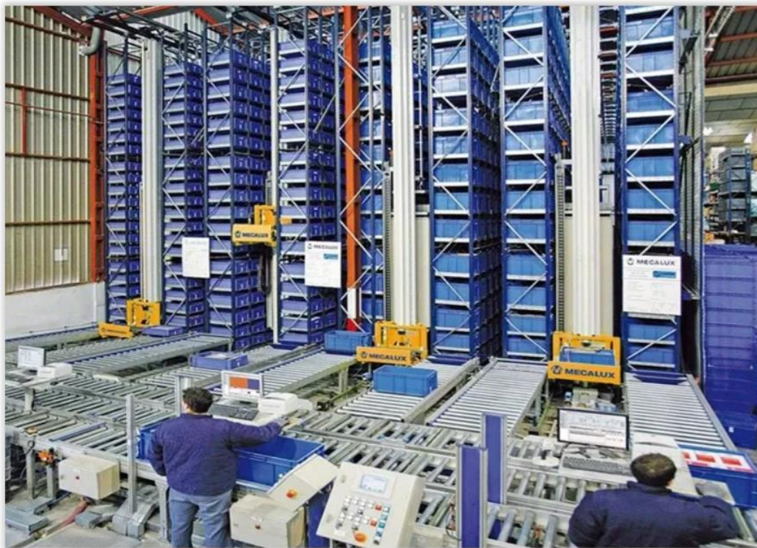
Slika 4. Sustav automatiziranog skladištenja i odlaganja
