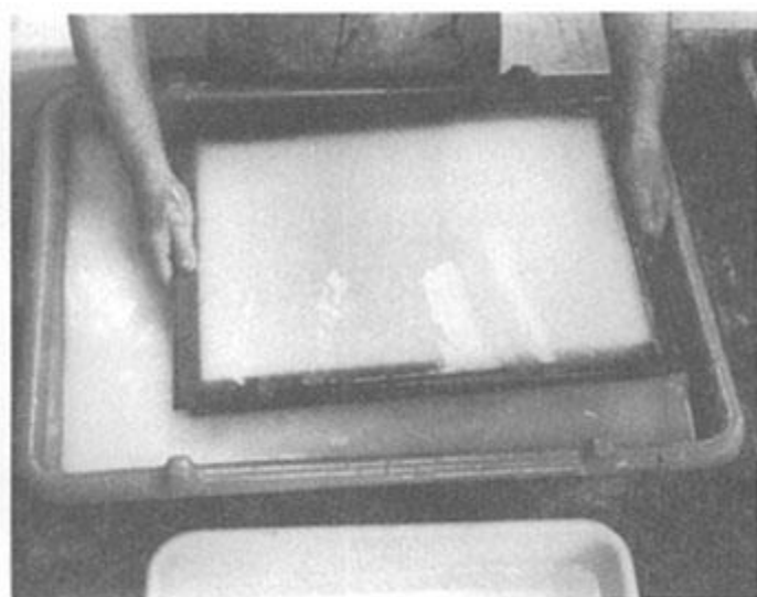
Slika 5 Sloj vlakana koji je formiran nakon cijedenja
