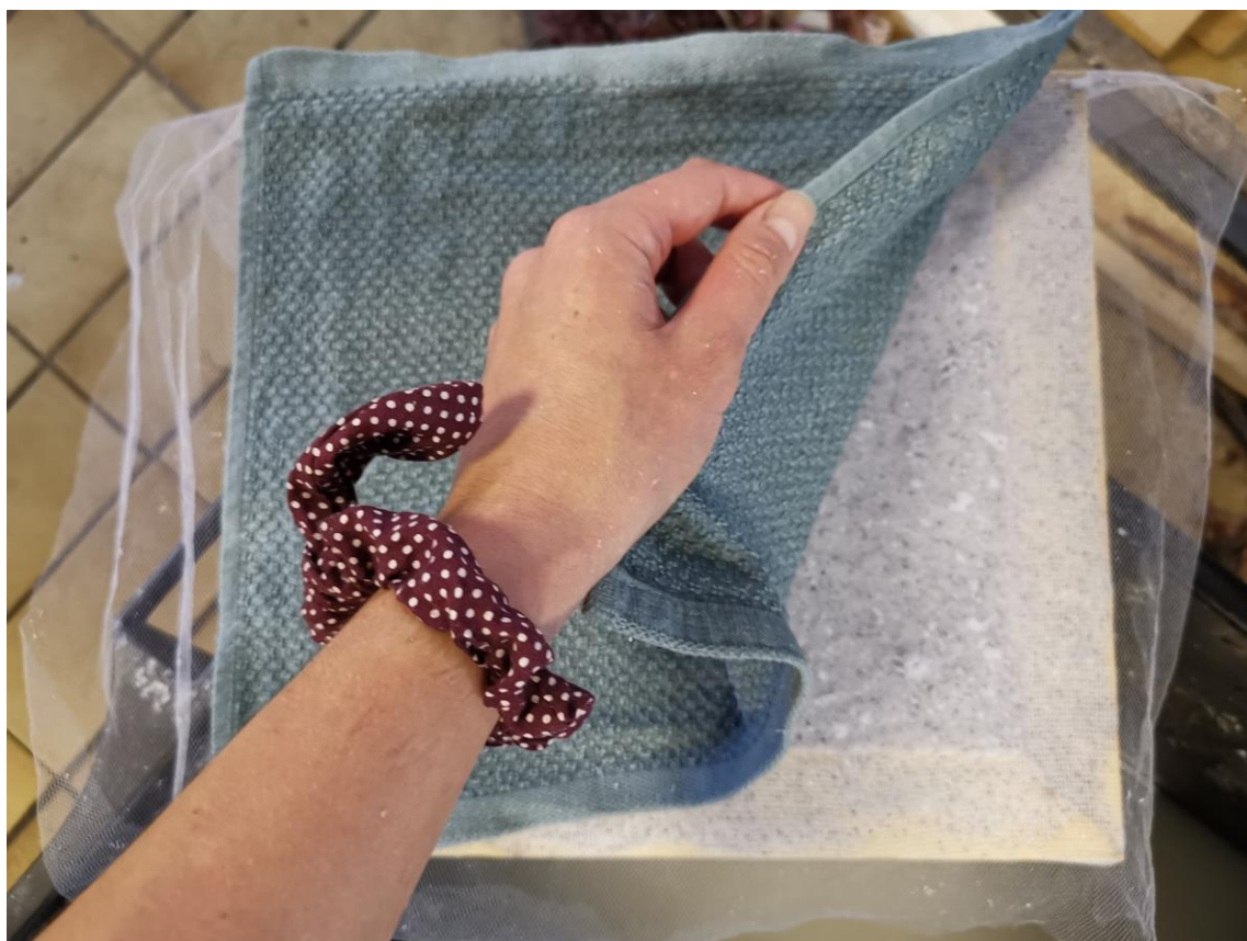
Slika 24 Uklanjanje ostatka vode sa papira ručnikom
