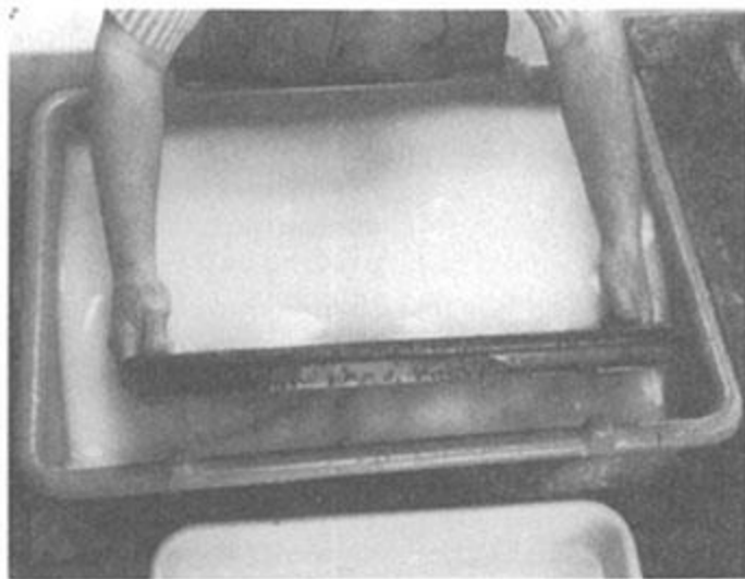
Slika 3 Umakanje kalupa u vodu
