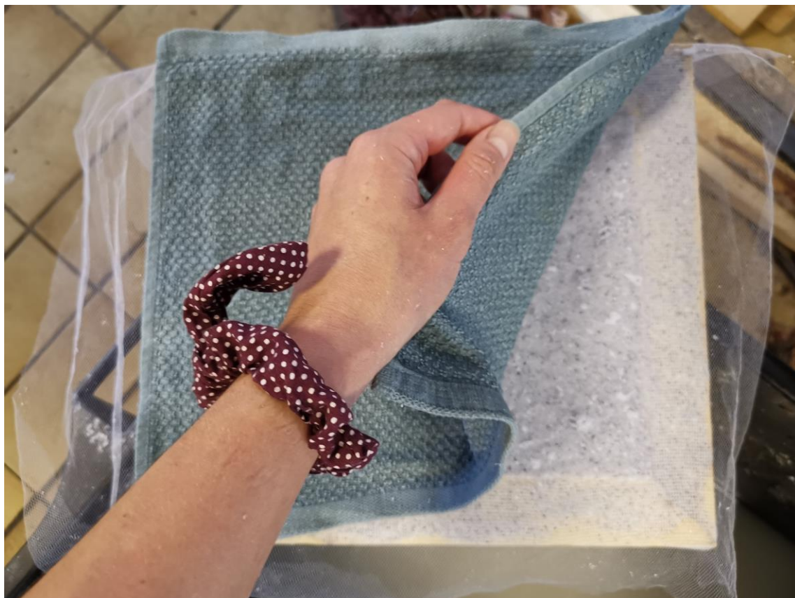
Slika 24 Uklanjanje ostatka vode sa papira ručnikom
