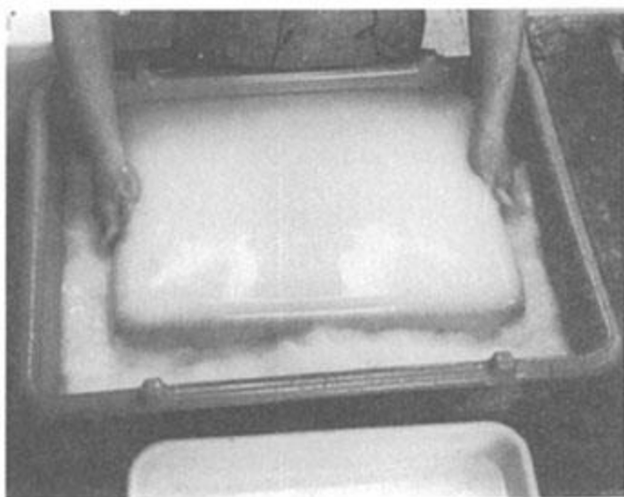
Slika 4 Izvlačenje kalupa iznad površine vode što dopušta cijedenje viška vode i pulpe, laganim pokretima nagnje se na sve strane što omogućava ravnostranivanje vlakana
