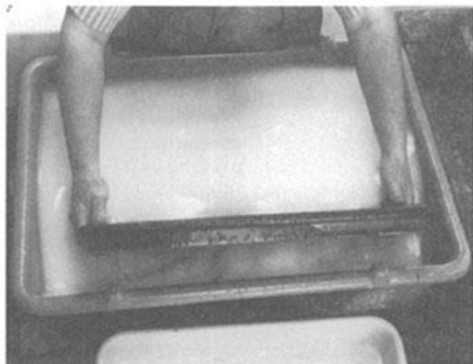
Slika 3 Umakanje kalupa u vodu
