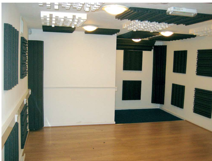
Slika 2.5 14 Akustični tretman sobe s apsorbirajućim panelima, difuzorima i bas zamkama
