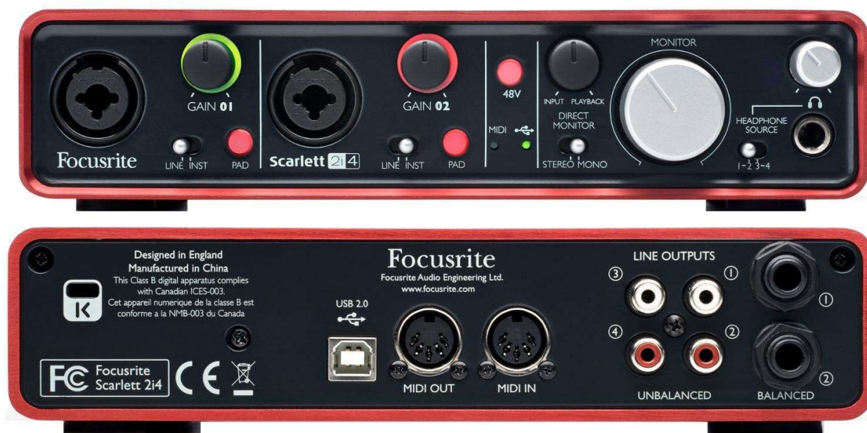
Slika 2.2 10 Focusrite Scarlett 2i4 audio sučelje, ulazni i izlazni dio
