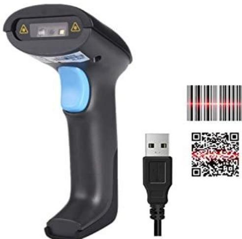
Slika 12. Ručni čitač crtičnog koda (barcode scanner), izvor:
