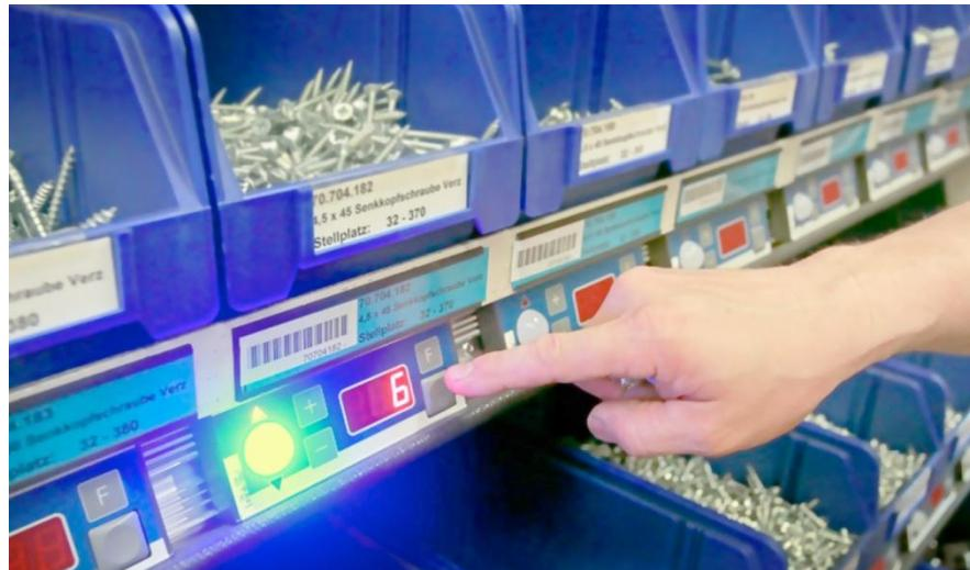
Slika 8. Pick To Light uređaj u skladištu , izvor: <https://www.kbs-gmbh.de/en/classiv-pick-by-light-module-for-shelving-systems/> (pristupljeno 29. kolovoza 2020.)
