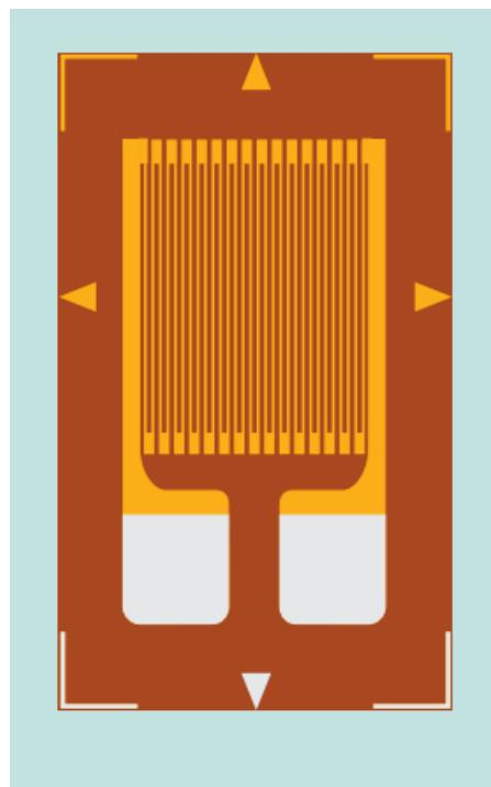
Slika 4.17 Odabrani tip elektrootporne mjerne trake [11]
