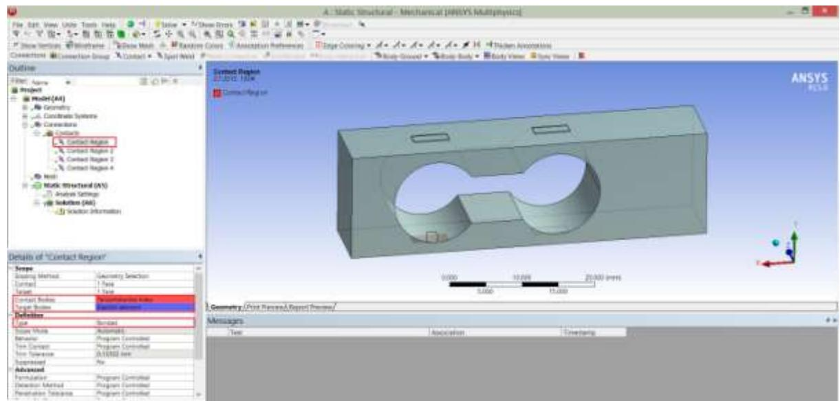
*Slika 3.12 Kontaktne površine*
