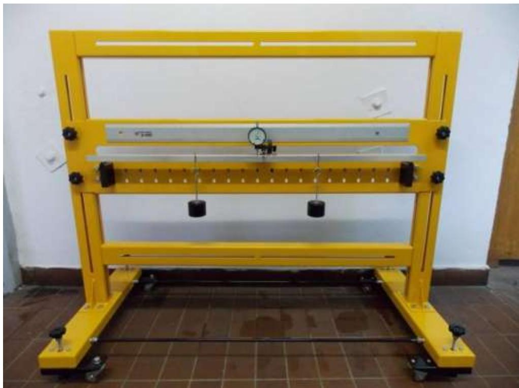
Slika 1.1 Didaktički uređaj za mjerjenje progiba grede [1]
