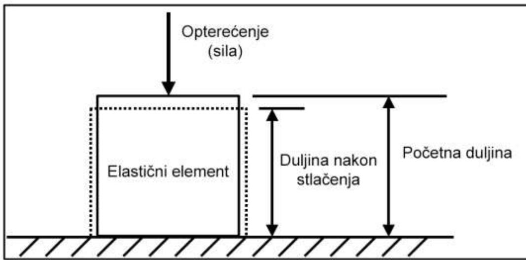
Slika 2.1 Osnovni način rada elastičnog elementa [4]
