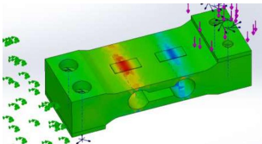
Slika 4.8 Raspodjela linijskih deformacija za gredni element
