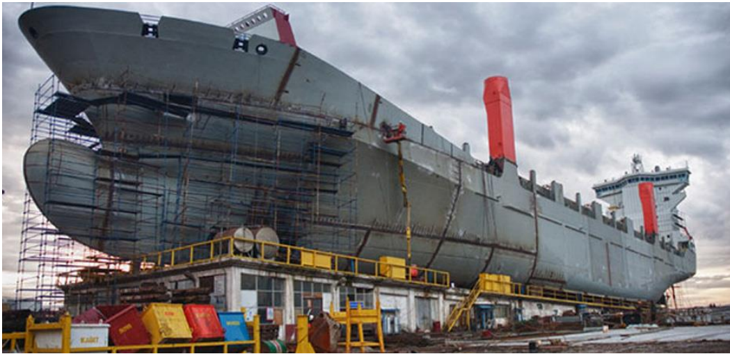
Slika 2: Pojedinačna proizvodnja - izgradnja broda
