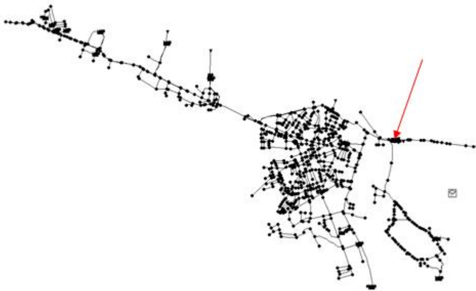
Slika 3.1. Situacijski prikaz sustava odvodnje Varaždin – izvadak hidrauličkog matematičkog modela s naznačenom lokacijom analiziranog preljeva
