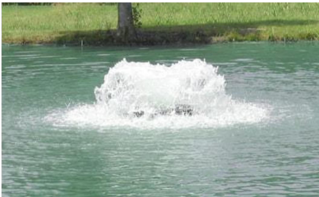
Slika 5.18. Površinski aerator za dubinu vode manju od 2 m (Izvor: https://www.pondaeration.ca/industrial-tailings-water-treatment.html )
