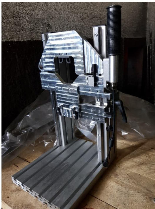
Slika 4.13 Primjer 3 - aluminijsko postolje za uređaj
