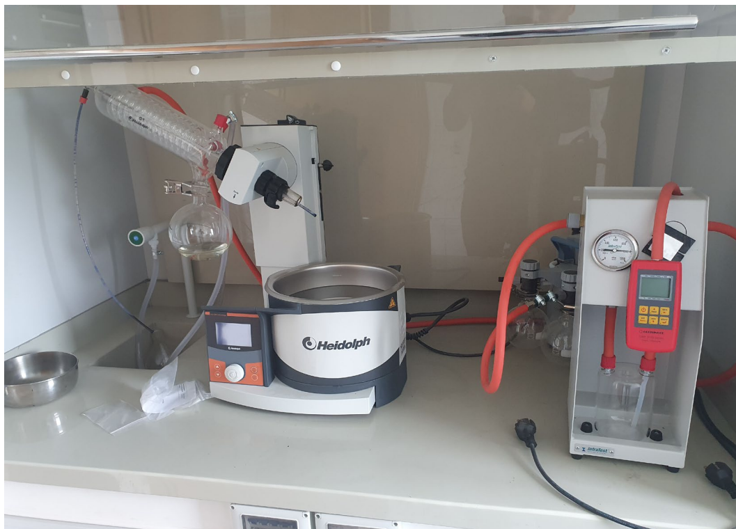
Slika 2.3 Uređaj za ispitivanje bitumena (vlastiti izvor)
