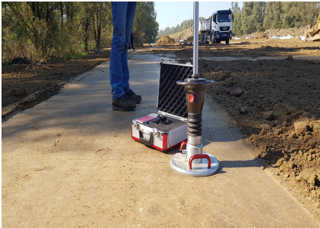
Slika 4.6 Ispitivanje posteljice kružnom pločom (vlastiti izvor)
