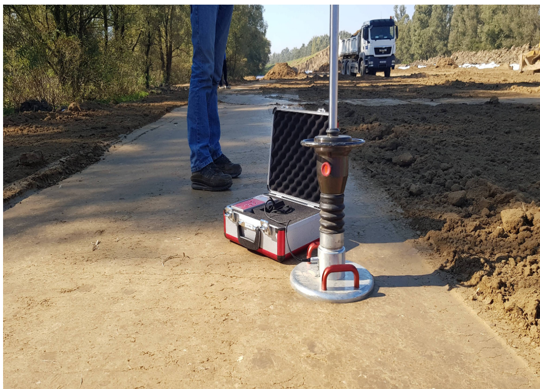
Slika 4.6 Ispitivanje posteljice kružnom pločom (vlastiti izvor)
