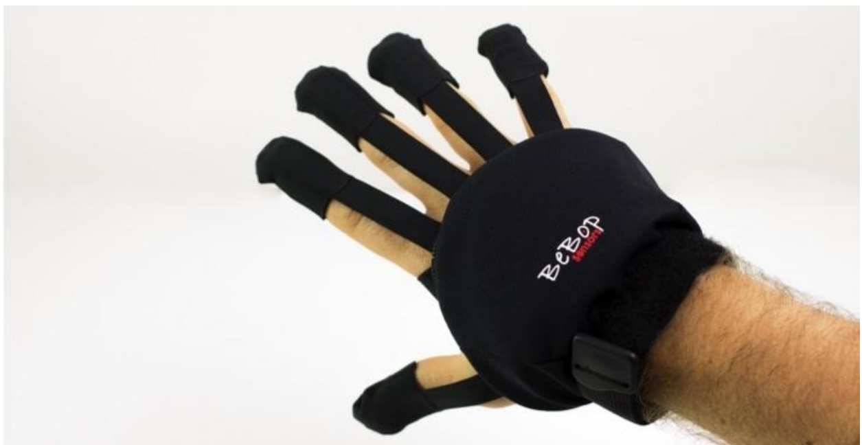
Slika 4-2 Primjer podatkovne rukavice[28]
