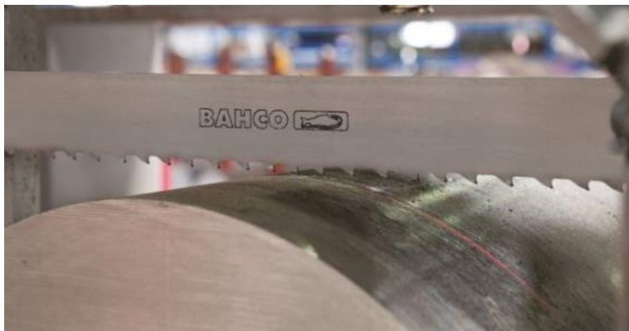
Slika 4.7.1. Zub pile za legure nikla
