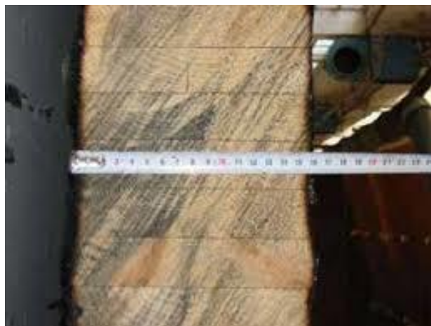
Slika 7.4 Lamelirani nosač nakon požara
