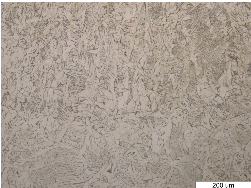
Slika 34 . Mikrostruktura korijena zavara pri povećanju 200 x - Uzorak 2
