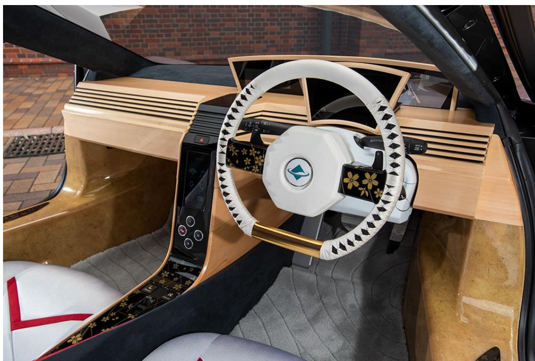
Slika 18. Automobil od nanofibre celuloze
