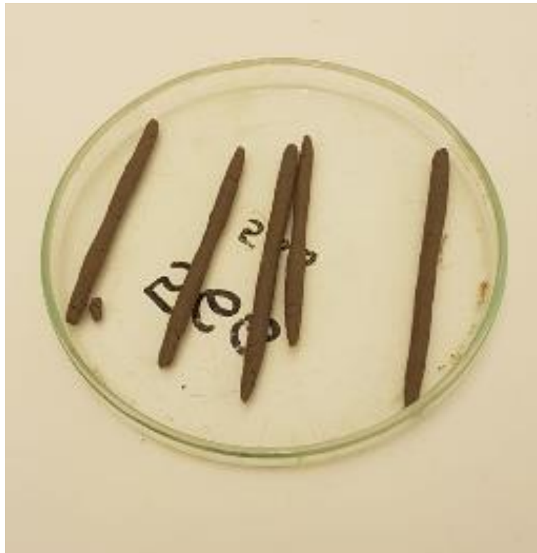
Slika 3.3. Pripremljeni uzorci valjčića kod ispitivanje granica plastičnosti
