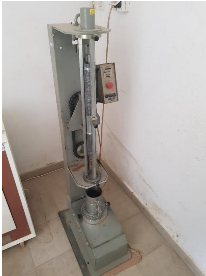
Slika 3.5. Laboratorijska aparatura za Proctor-ov pokus
