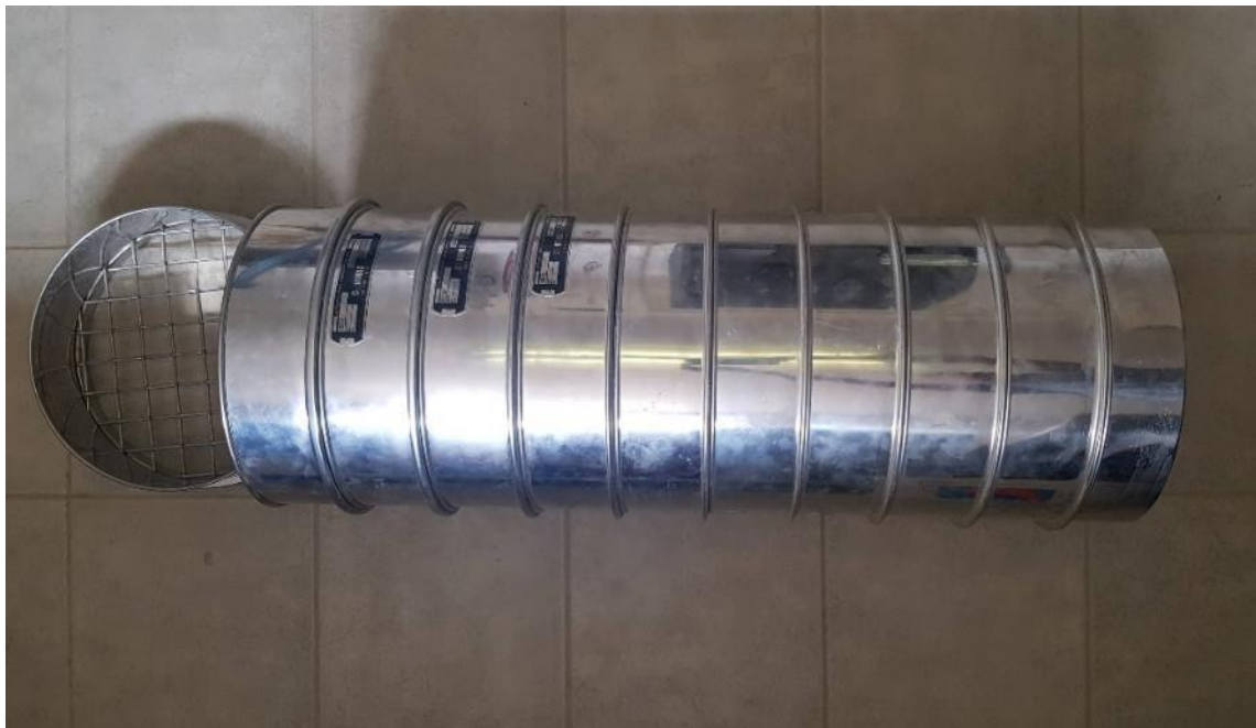
Slika 3.7. Set laboratorijskih sita za ispitivanje granulometrijskog sastava sijanjem
