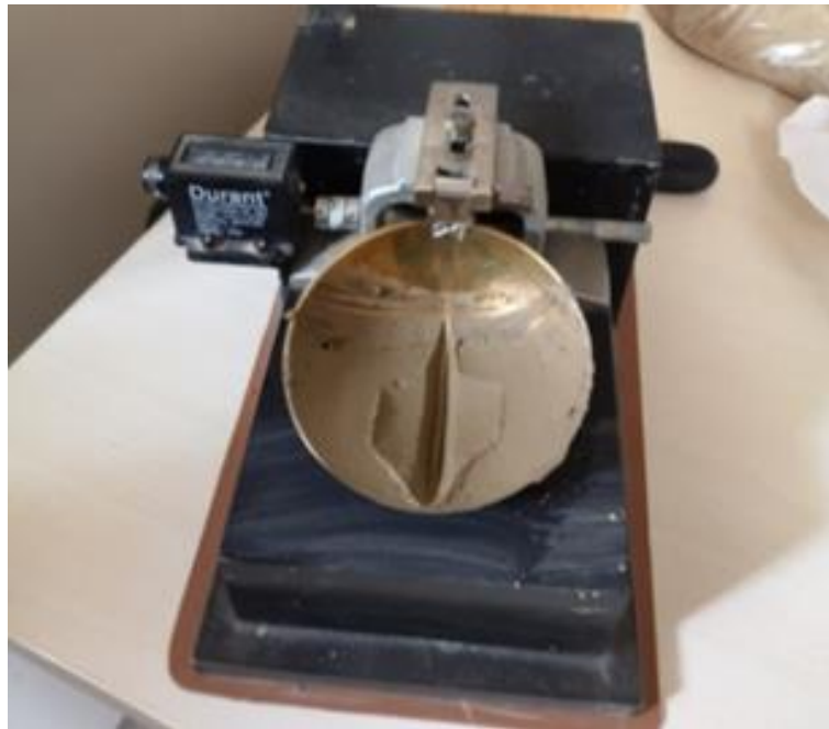
Slika 3.1. Casagrandeov uređaj sa ispitnim uzorkom
