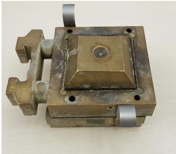
Slika 3.11. Prikaz ćelije izravnog posmika sa ugrađenim uzorkom
