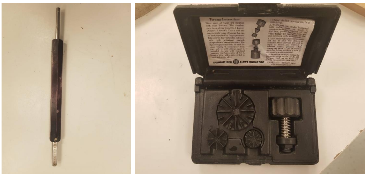
Slika 2.4. Džepni penetrometar i džepna krilna sonda
