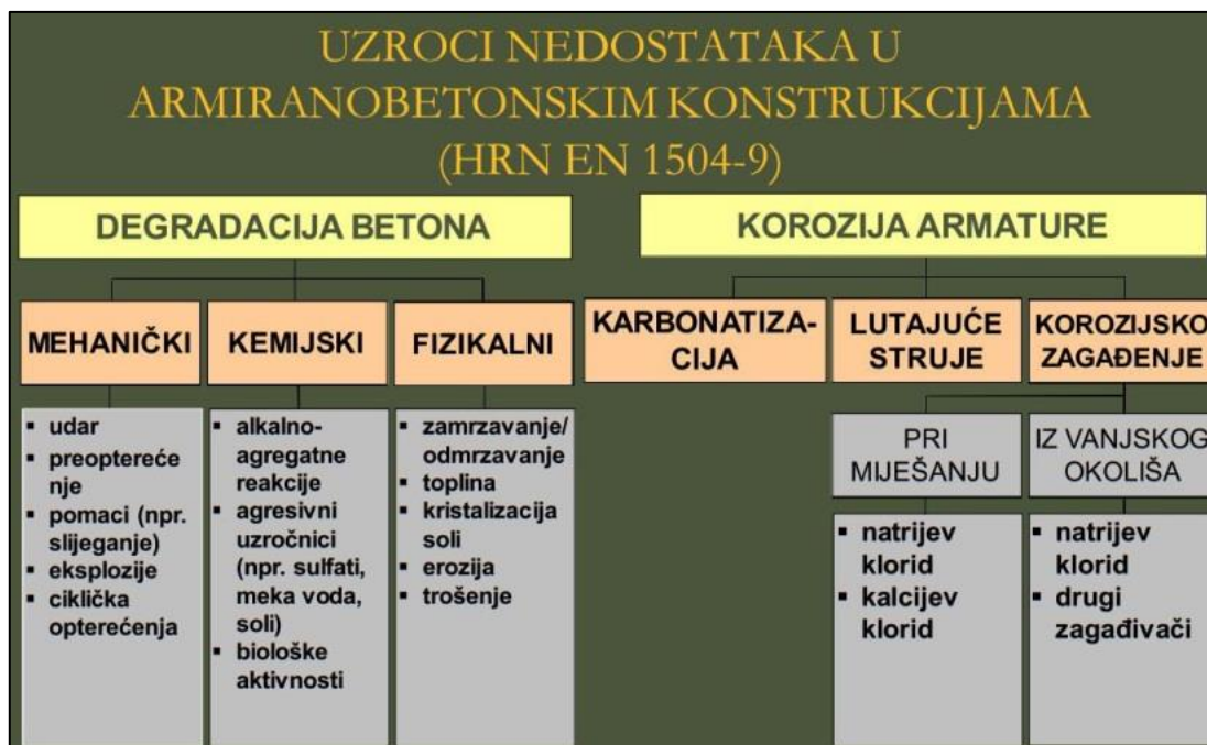
Slika 5. Uzroci nedostataka u AB konstrukcijama
