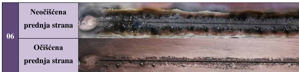
Slika 57. Prikaz nanešenih aktivacijskih premaza prije zavarivanja
