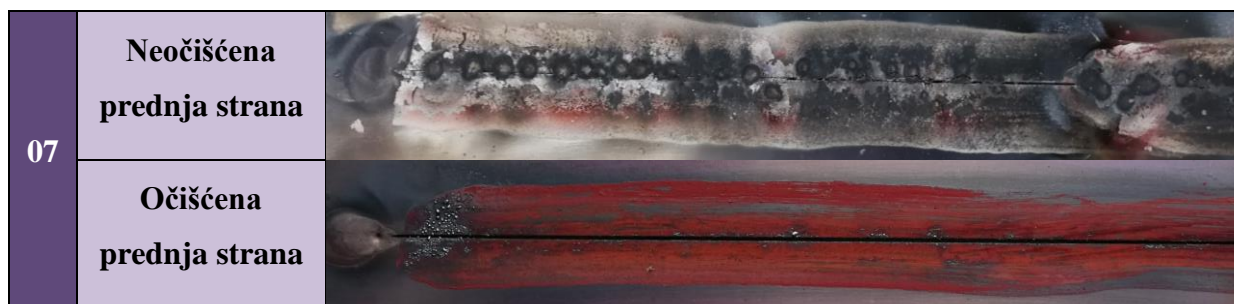
Tablica 26. Prikaz neočišćenih i očišćenih zavara s prednje strane
