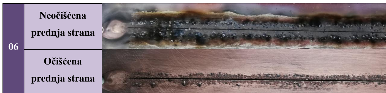
Slika 57. Prikaz nanešenih aktivacijskih premaza prije zavarivanja
