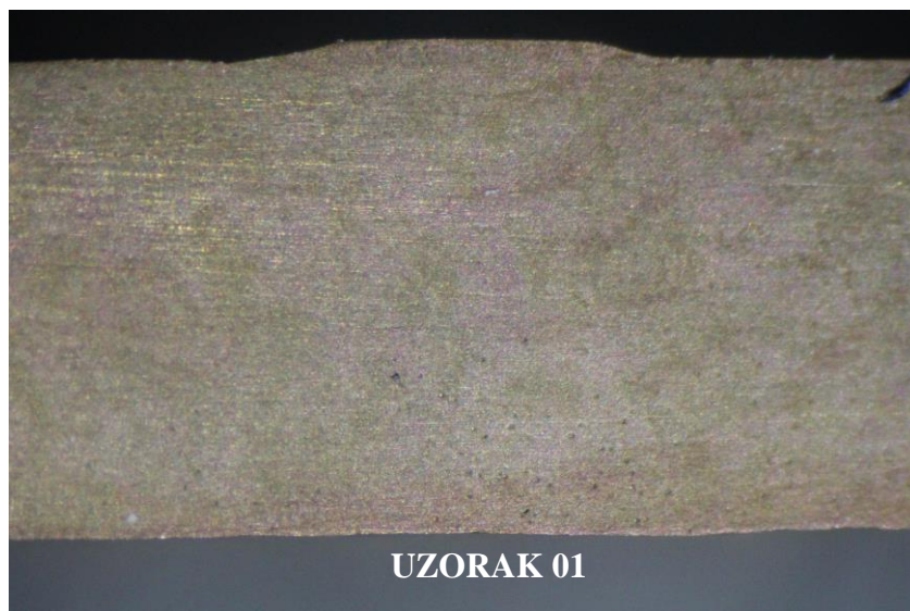
Slika 58. Poprečni presjek zavarenog spoja uzorka 01
