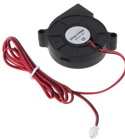
Slika 28. Prikaz ventilatora tipa 5015 za hlađenje zraka [27]
