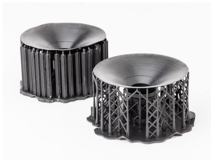
Slika 3. 3D ispis objekta s potporama [5]
