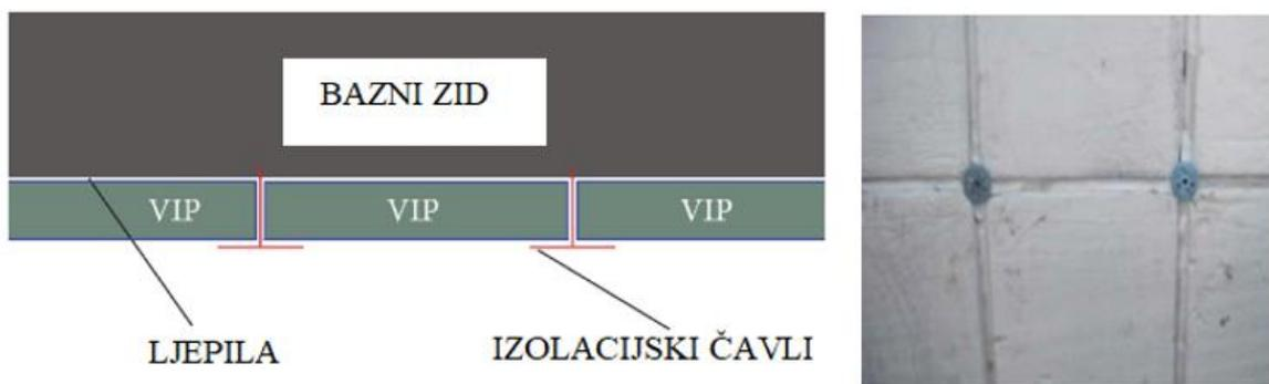
**Slika 5.2.7.** Shematski i stvarni prikaz montiranja panela
