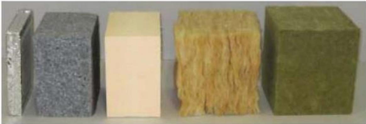
**Slika 5.2.2.** Debljine (VIP, EPS, XPS, mineralna vuna, kamena vuna) za  $U = 0.3 \text{ W/ m}^2\text{K}$
