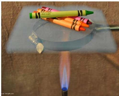
Slika 5.1.4. Toplinski otpor uzorka aerogela
