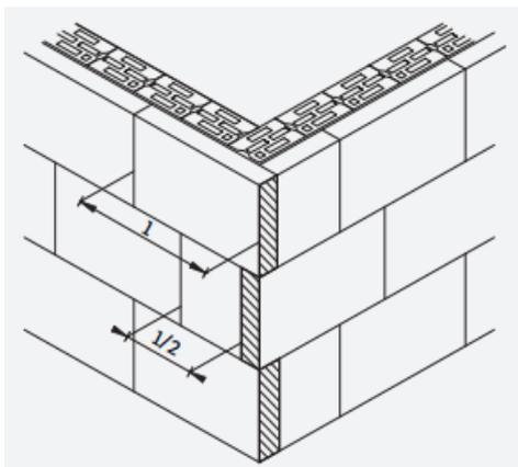
**Slika 6.1.2.** Preklapanje TI na uglu
