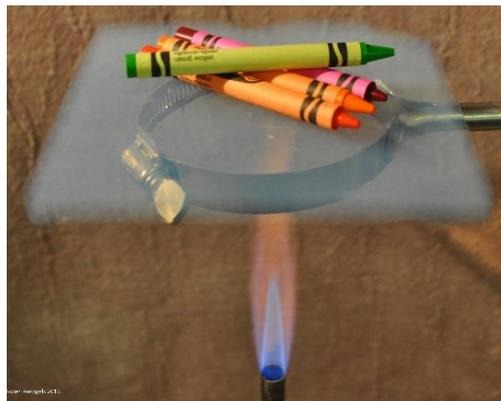
**Slika 5.1.4.** Toplinski otpor uzorka aerogela
