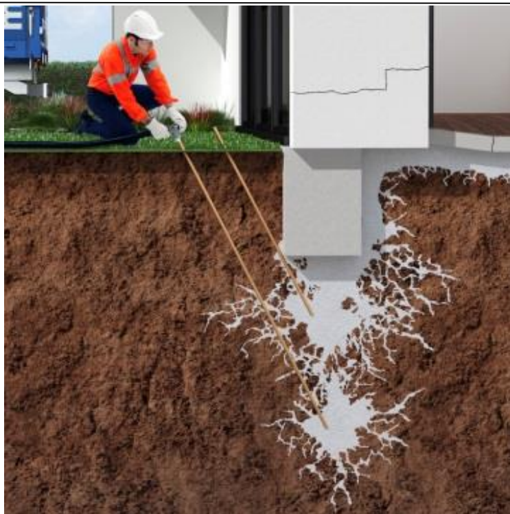
Slika 4.25. Naknadno ojačanje temeljnog tla uz primjenu kemijskog injektiranja s površine i bez razaranja postojeće konstrukcije i temelja;
