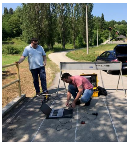
Slika br.4.2. Priprema za ispitivanje metodom Impact-Echa
