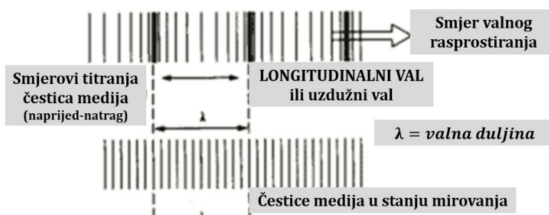
Slika br. 3.9. Prikaz smjera valnog rasprostiranja i smjerova titranja
