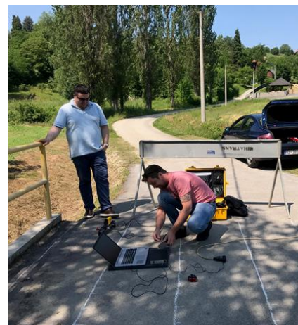
Slika br.4.2. Priprema za ispitivanje metodom Impact-Echa
