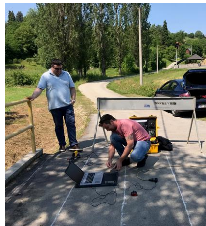
Slika br.4.2. Priprema za ispitivanje metodom Impact-Echa
