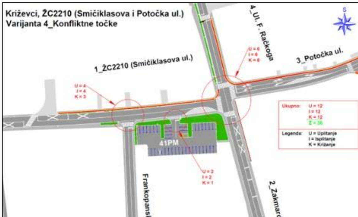
Slika 20. Analiza konfliktnih točaka Varijanta 4. na raskrižju ŽC2210 (Smičiklasova i Potočka ul.) i nerazvrstane ceste (Ul. F. Račkoga i Zakmardijeva ul.) [1]
