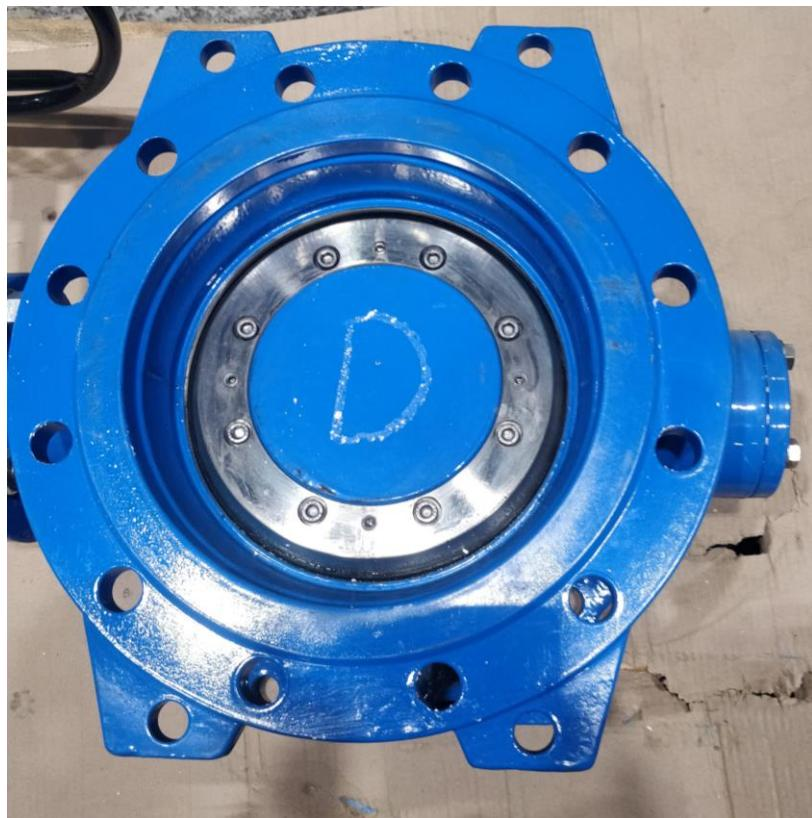
*Slika 30. Primjer označavanja ispitanoj i ispravnoj komadi*
