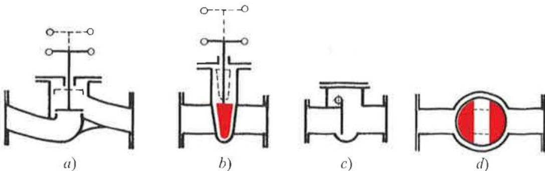
Slika 1. Skice osnovnih vrsta zapornih organa: a) ventil, b) zasun, c) zaklopka, d) pipac [3]
