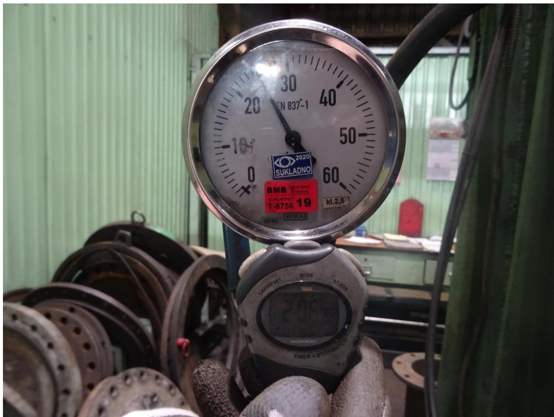
Slika 23. Trajanje ispitivanja čvrstoće i nepropusnosti kućišta
