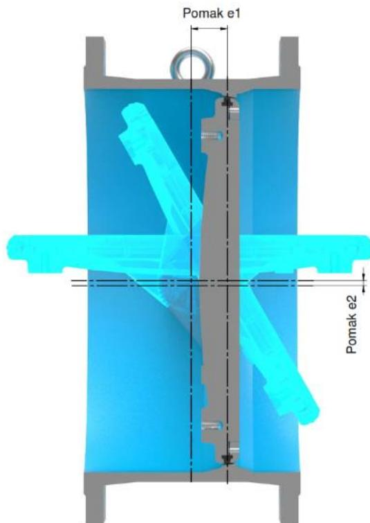
*Slika 5. Horizontalni i vertikalni pomak osi rotacije*
