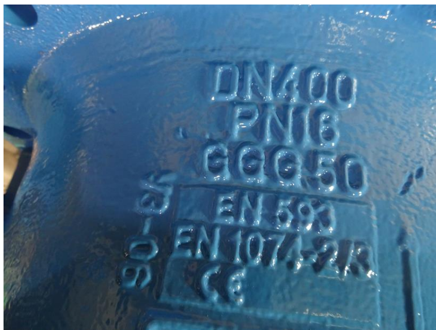
Slika 20. Leptirasti zatvarač DN 400 PN 16
