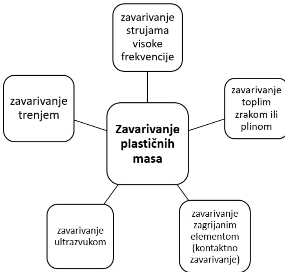
Slika 3.1. Najvažniji postupci zavarivanja plastičnih masa [13]
