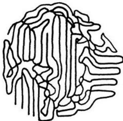
Slika 1.2.6.2. Polukristalni polimer (amorfna i kristalna struktura) [2]
