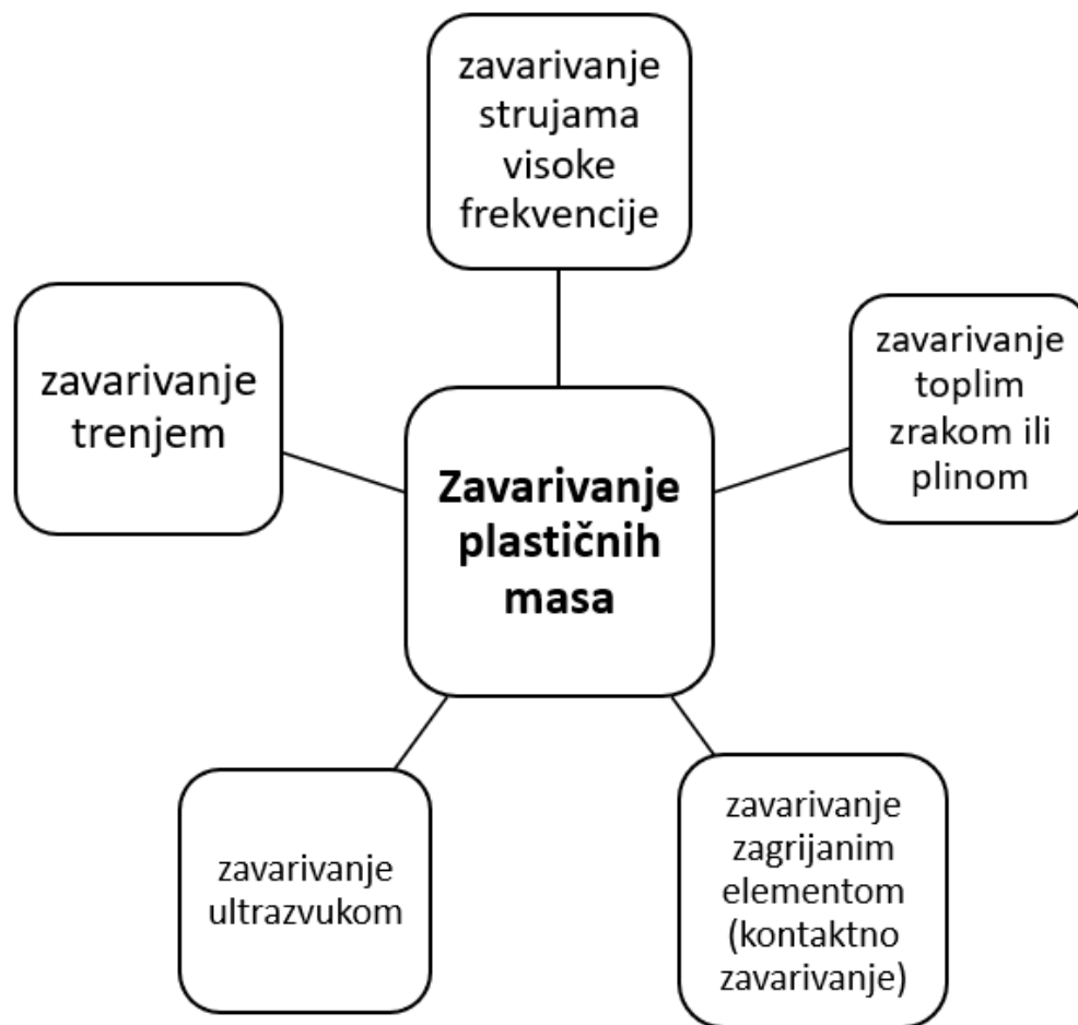
Slika 3.1. Najvažniji postupci zavarivanja plastičnih masa [13]
