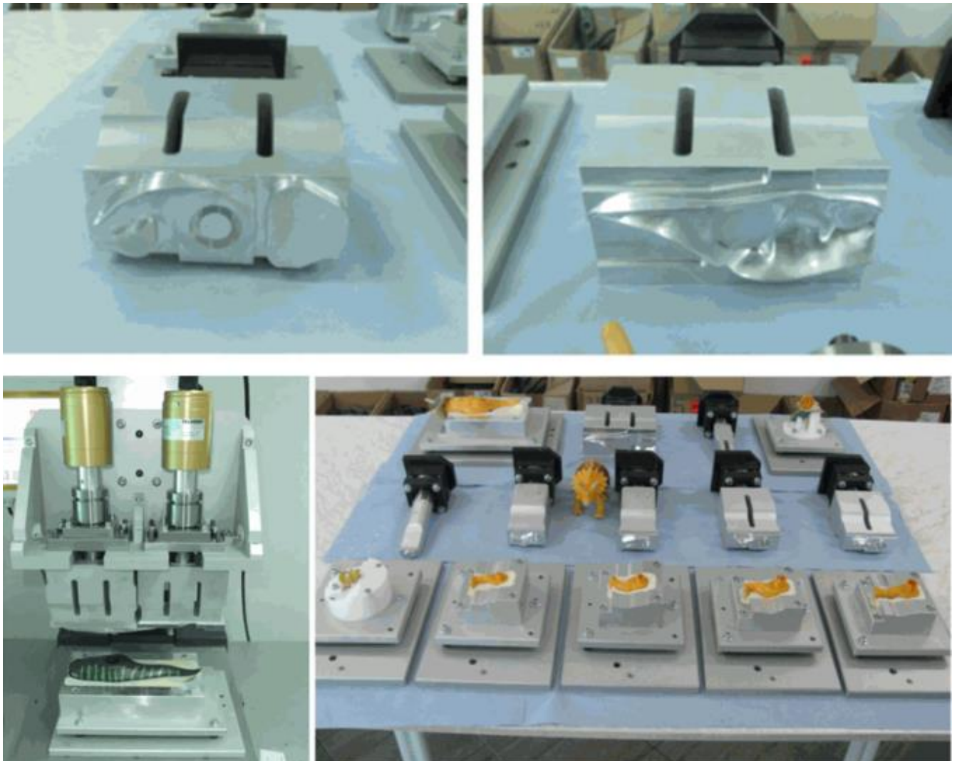
Slika 4.4.2. Sonotrode (alati za zavarivanje) [39]
