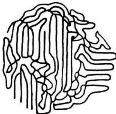
Slika 1.2.6.2. Polukristalni polimer (amorfna i kristalna struktura) [2]
