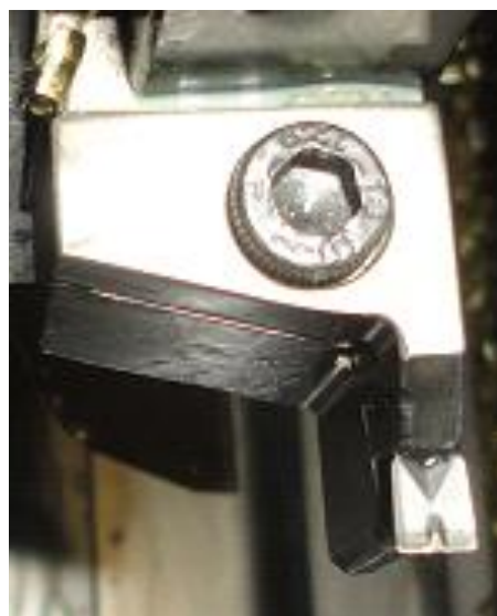
Slika 6.18. Nož za tokarenje s pločicom za vanjski utor [15]
