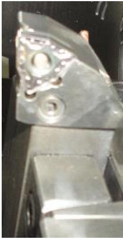
Slika 6.10. Nož za tokarenje sa pločicom za grubo vanjsko tokarenje (TRIGON) [15]
