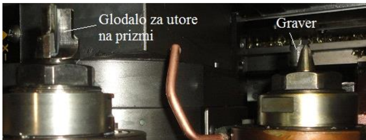
Slika 6.23. Glodalo za gravuru i glodalo za utore na prizmi u gonjenom prihvatu [15]
