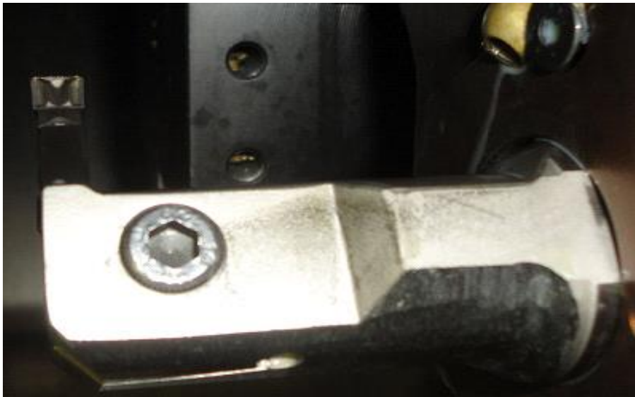
Slika 6.12. Nož za tokarenje sa pločicom za unutarnji utor [15]
