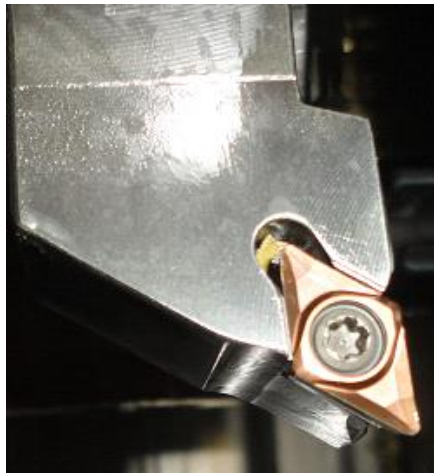
Slika 6.16. Nož za tokarenje s pločicom za fino vanjsko tokarenje [15]
