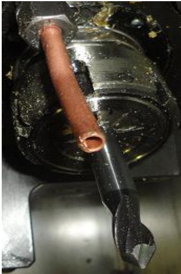
Slika 6.15. Alat za izradu gravure po obodu u gonjenom prihvatu [15]
