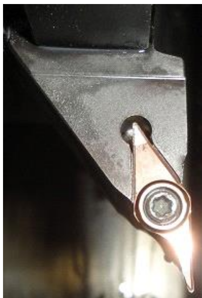
Slika 6.19. Nož za tokarenje s pločicom za fino tokarenje prizme (podbrušeni) [15]
