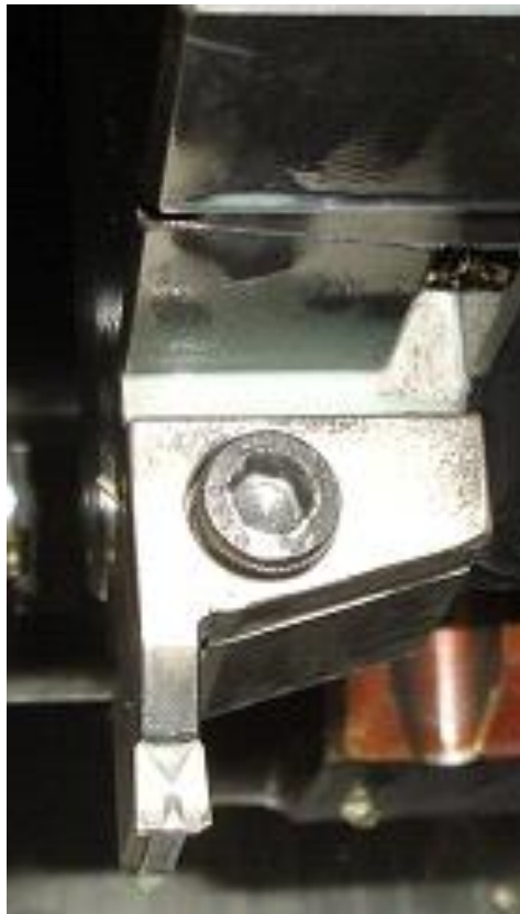
Slika 6.11. Nož za tokarenje s pločicom za vanjski utor [15]
