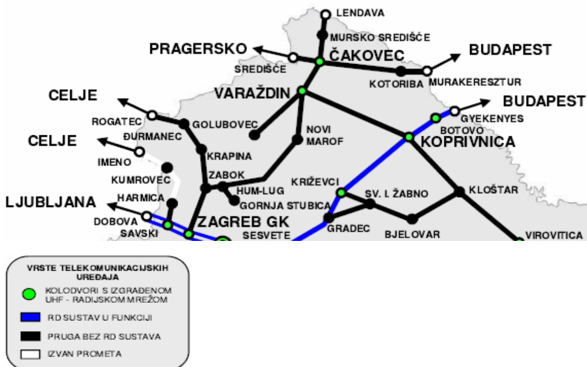
Slika 8. Vrste telekomunikacijskih uređaja željezničkih kolodvora u RH, pruga R202 Varaždin-Dalj, kolodvor Varaždin i Koprivnica
