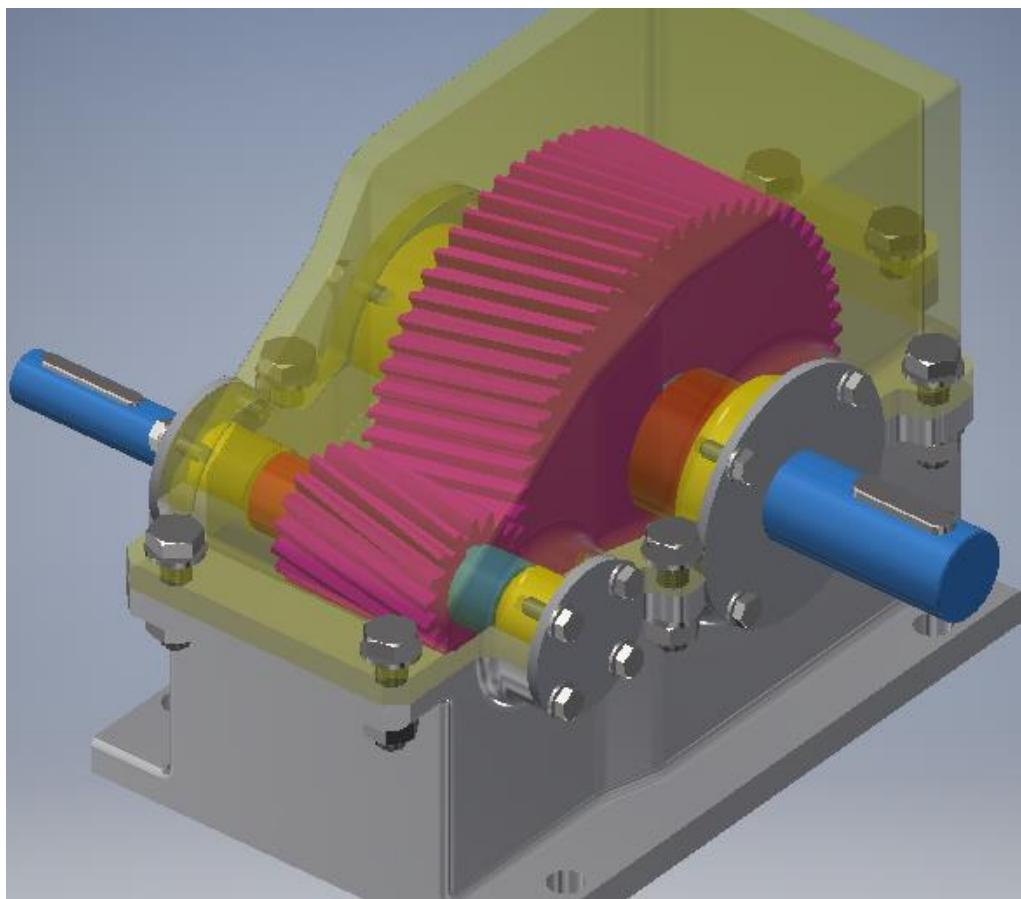
Slika 9.11. Ubacivanje i spajanje vijčanom robom
