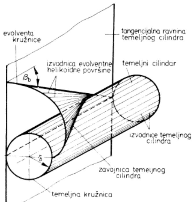
Slika 3.2. Prikaz nastajanja evolventnog boka zuba [12]
