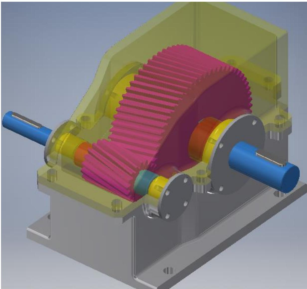
Slika 9.9. Ubacivanje gornjeg dijela kućišta i poklopaca ležajeva
