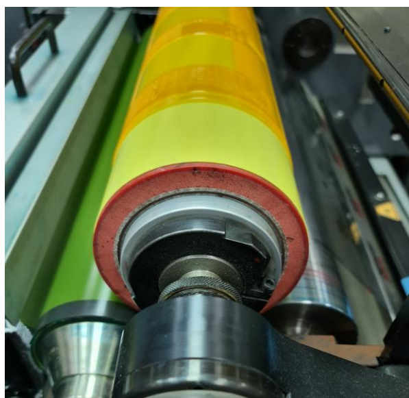
Slika 2.19 Točke pritiska tiska
