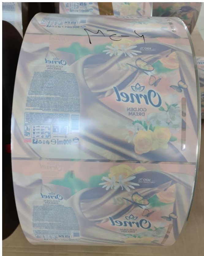
Slika 4.5 Zrcalni tisak transparentne folije
