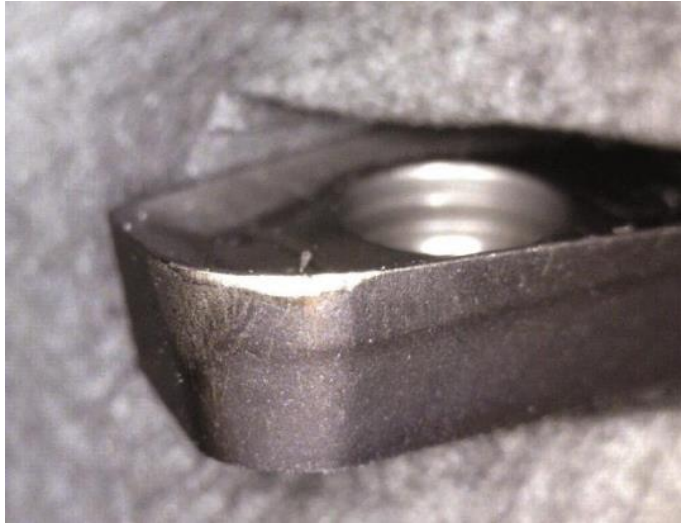
Slika 28. Trošenje radijusa nosa [21]
