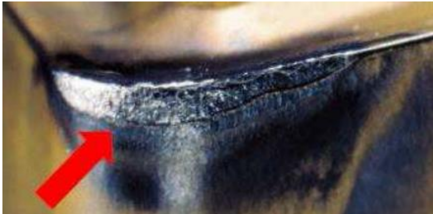
Slika 9. Trošenje na stražnjoj površini alata [2]
