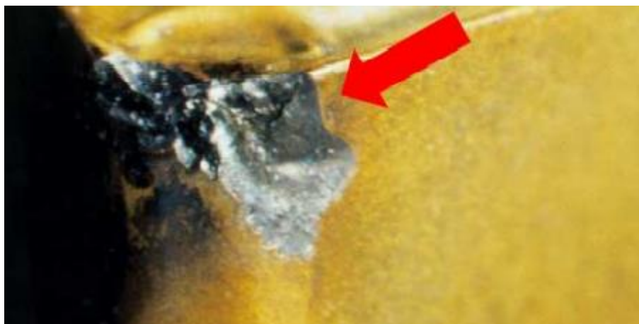
Slika 14. Lom rezne oštrice [2]
