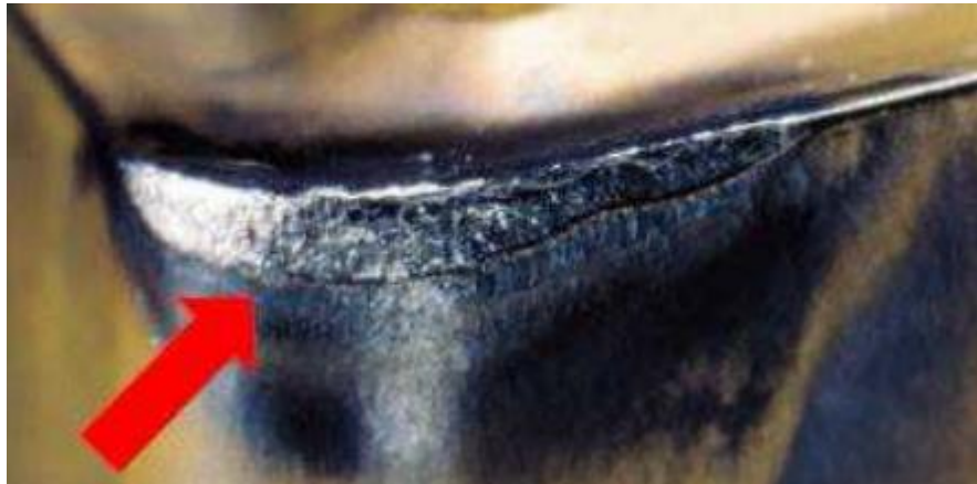
Slika 9. Trošenje na stražnjoj površini alata [2]
