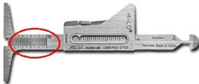
Slika 4.4. Prikaz očitavanja skale za nadvišenje zavara
