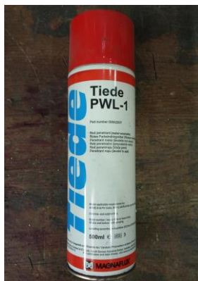
Slika 29. Crveni penetrant Tiede PWL-1
