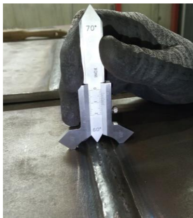
Slika 26. Ispitivanje dimenzija zavarenih uzoraka
