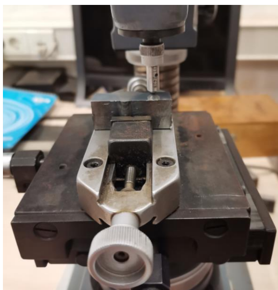
Slika 46. Utiskivanje indentora u površinu koja se ispituje
