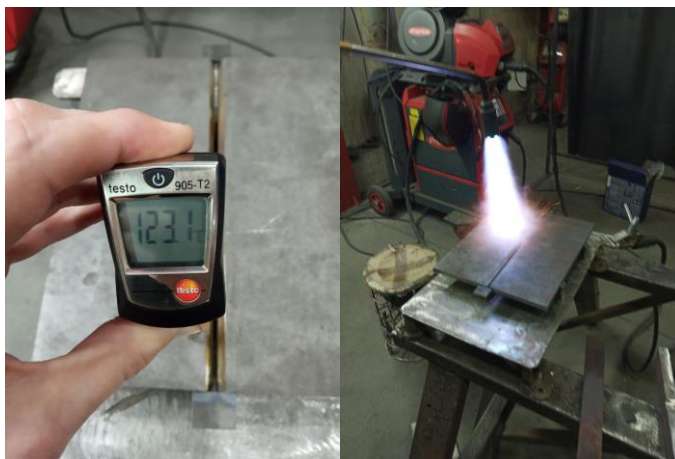
Slika 25. Mjerenje temperature predgrijavanja kod uzorka 2
