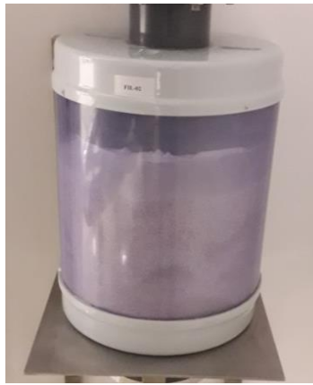
Slika 3.18. Spremnik natrijevog vapna (vlastiti izvor)
