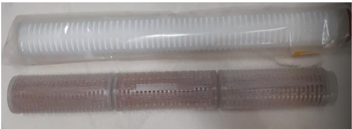
Slika 3.12. Novi i zasićeni 2,5 \mu m filter pred pripreme (vlastiti izvor)
