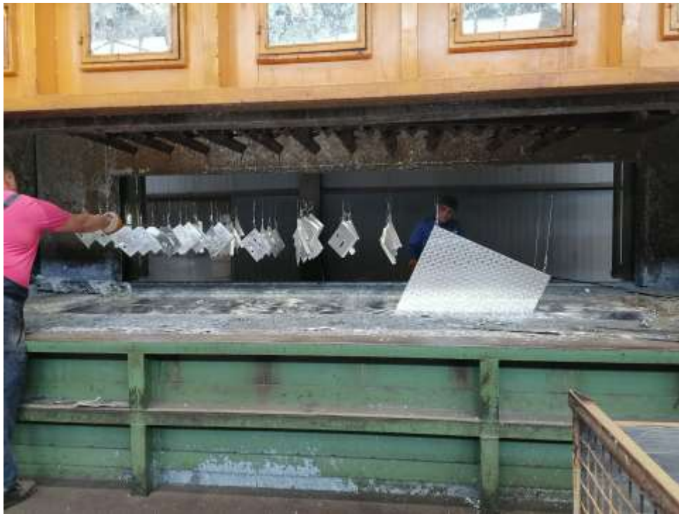
Slika 17 - Uranjanje komada u rastaljeni Zn
