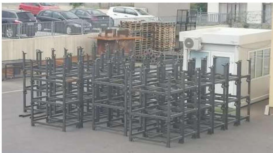
Slika 22 - Komad X prije postupka vrućeg pocinčavanja
