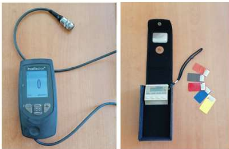
Slika 24 - Uređaji za mjerenje debljine prevlake Zn
