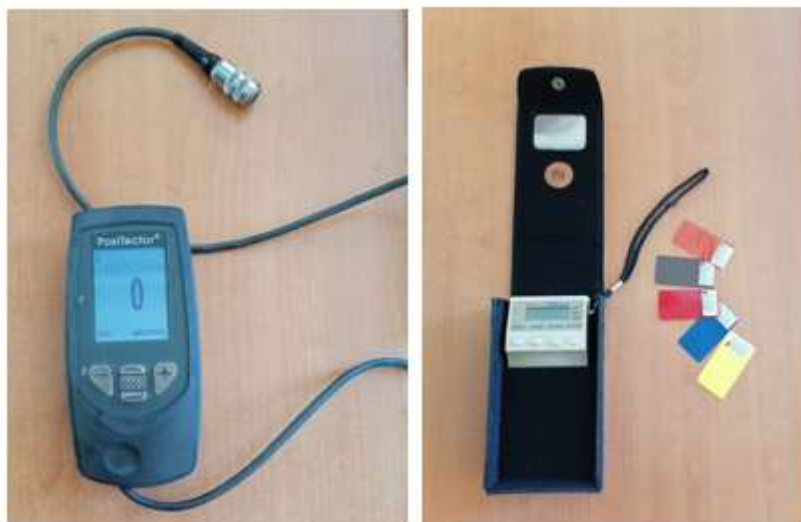
Slika 24 - Uređaji za mjerenje debljine prevlake Zn
