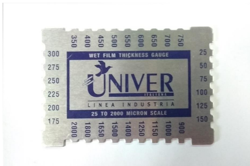
Slika 31: Češalj za mjerenje debljine mokrog filma premaza korišten za mjerenje
