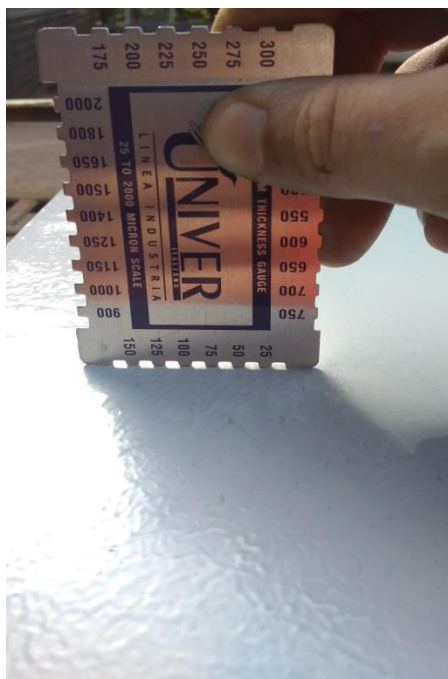
Slika 36: Postupak mjerenja debljine mokrog fila temeljnog premaza
