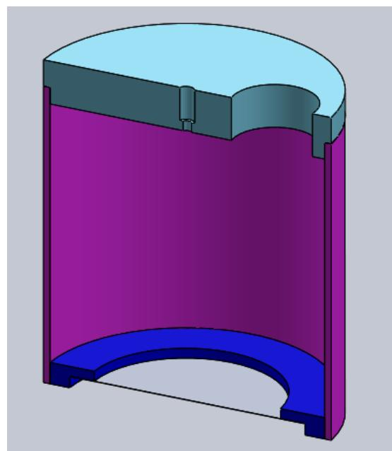
Slika 3.5 Cilindar potiskivača u presjeku
