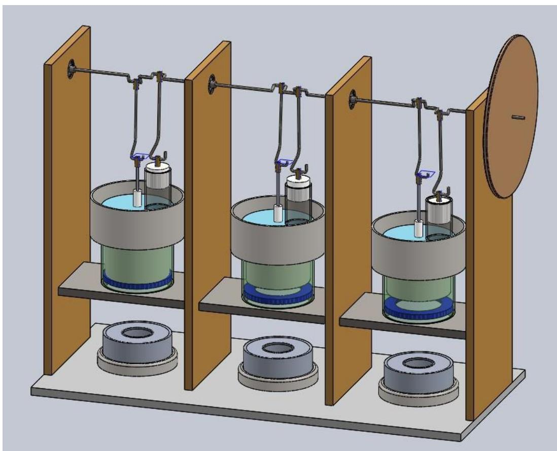
Slika 3.1 3D model 3 cilindarskog stirling motora
