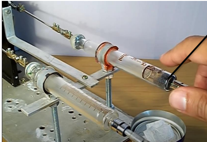
Slika 2.46 \alpha -stirling sa fiksnim regeneratom
