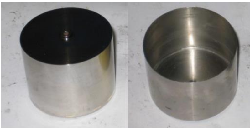
Slika 2.49 Primjer potiskivača od nehrđajućeg čelika -34grama
