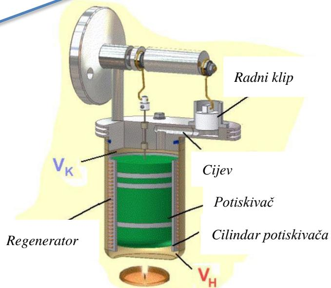
Slika 2.30  $\gamma$ -tip stirling motora u presjeku
