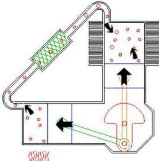
Slika 2.28 Četvrta pozicija α-stirling motora
