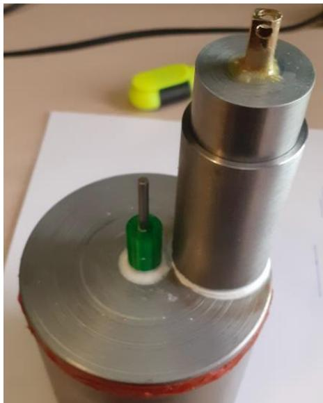
Slika 3.15 Spoj radnog klipa i cilindra
