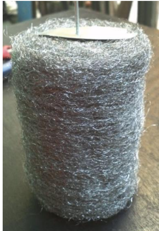
Slika 2.42 Primjer regeneratora (potiskivača)
