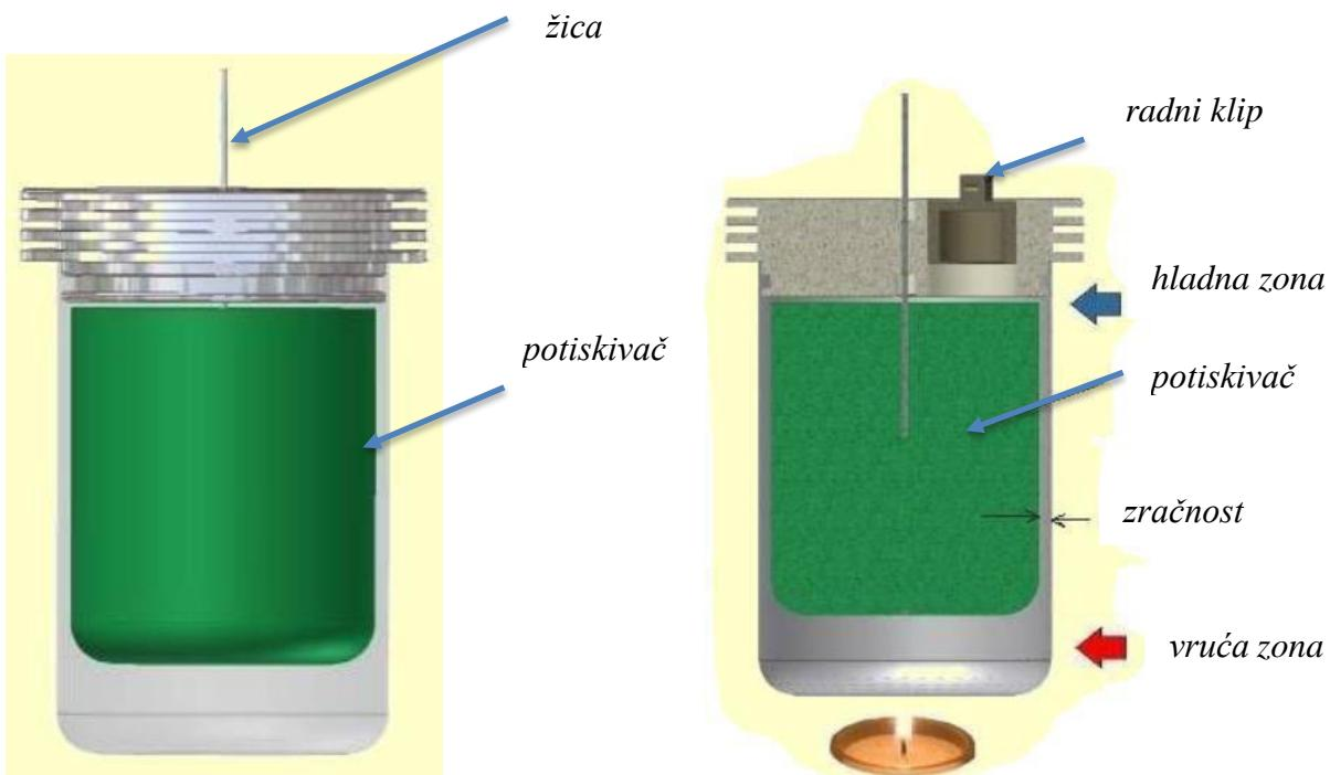
Slika 2.8 Potiskivač unutar cilindra
