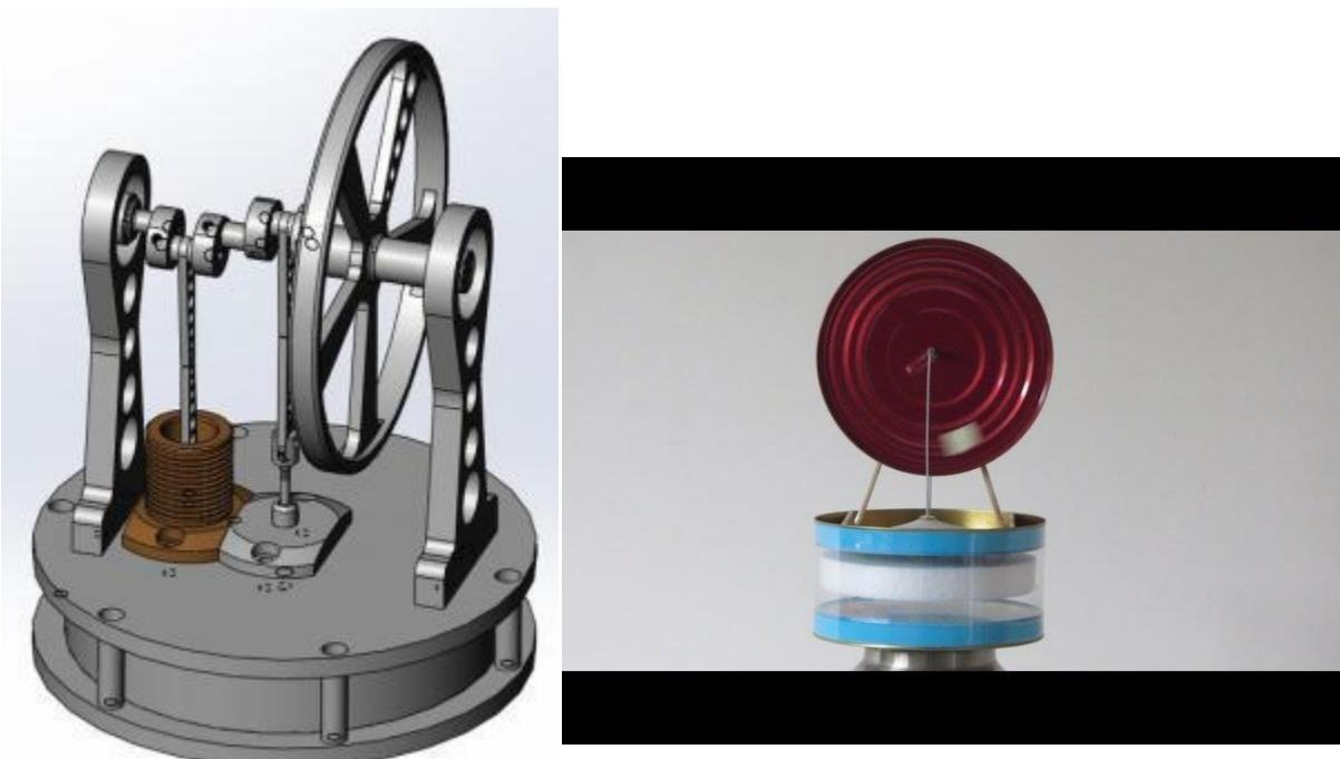
Slika 2.37 Primjeri LTD stirling motora
