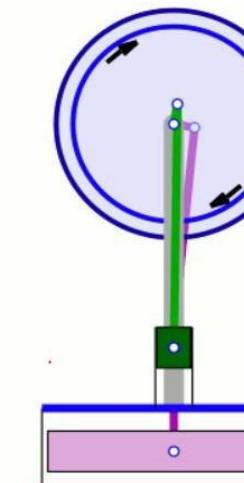
Slika 2.33 Treća pozicija γ-tip stirling motora
