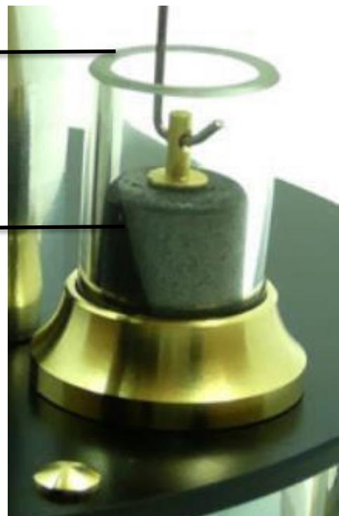
Slika 2.54 Cilindar radnog klipa i radni klip
