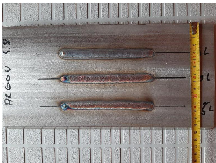
Slika 9.2. Širina inox ploče (širina osnovnog materijala)
