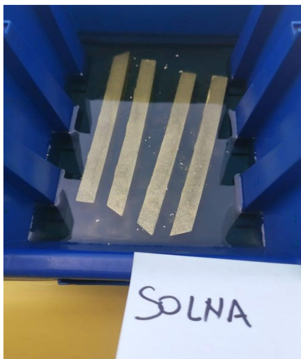
Slika 9.6. Uzorci uronjeni u solnu kiselinu 24,5%
