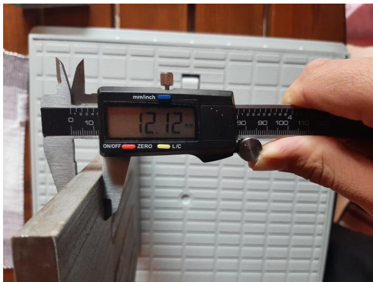
Slika 9.1. Debljina inox ploče (debljina osnovnog materijala)
