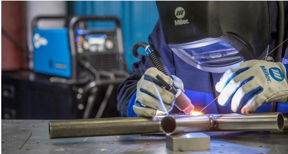
Slika 5.6. Prikaz zavarivača koji unosi dodatni materijal kod zavarivanja [19]
