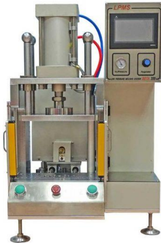
Slika 58 Linija za niskotlačno lijevanje polimerne mase
